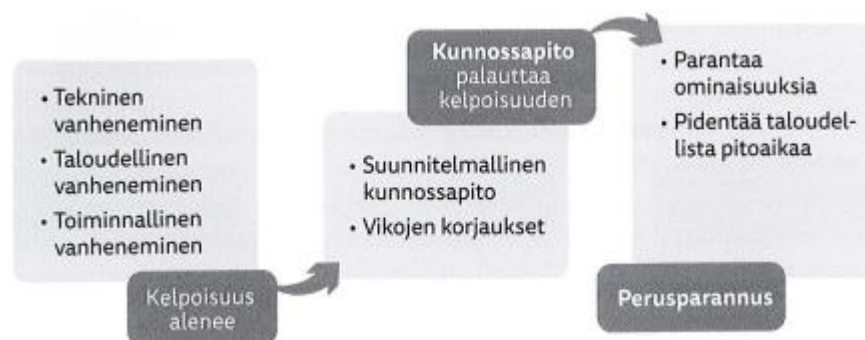
Kuva 2. Kunnossapidolla rakennus korjataan alkuperäisestä laatua vastaavaan tilaan. [11, s. 76]
