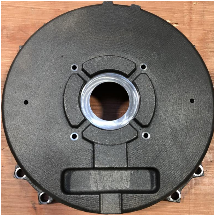
Kuva 4. Parannellun laakerikilven ulkopuoli.
