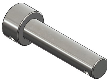
Kuva 6. Malli karamoottorin kiinnitys tapista
