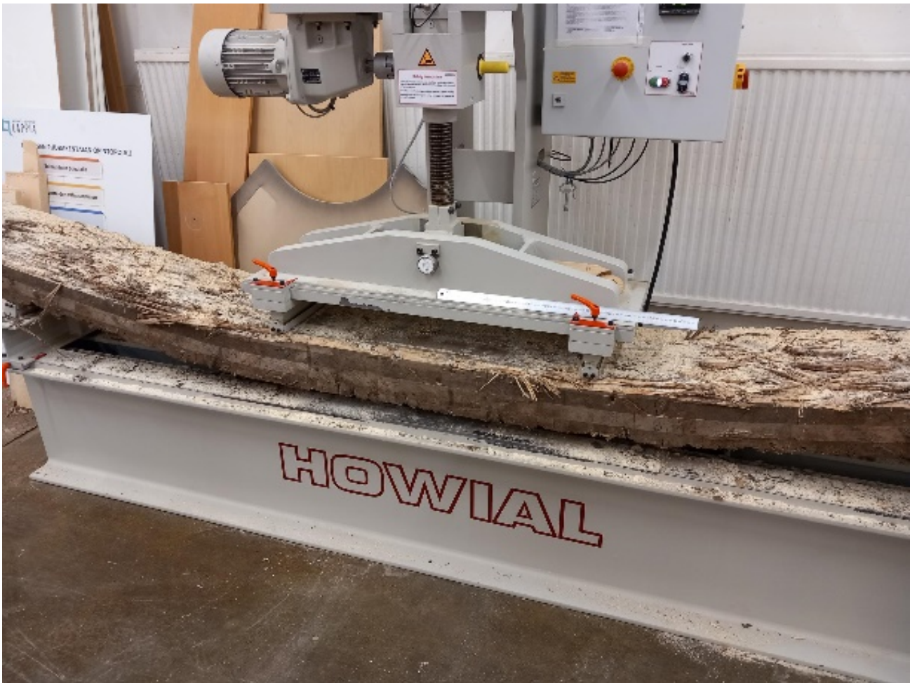
Kuva 8. Kuvassa levy, jonka pintalamellit ovat kantavina kerroksina. Näissä levyissä taivutus – ja jäykkyysominaisuudet alkavat heikentyä heti pintakerroksen ohetessa käytön seurauksena. Vetojännityskerros oli metsäkoneiden rikkoma, jolloin vetolujuus oli olematon. (Kuva Matti Yliniemi)
