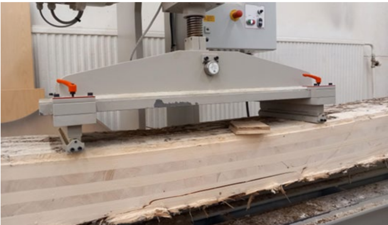
Kuva 1. Taivutus- ja taipumatestit tehtiin tätä varten valmistetulla taivutustestilaitteella ns. nelipistetaivutuksella Ammattiopiston CLT-oppimisympäristössä Kemissä. (Kuva Matti Yliniemi)
