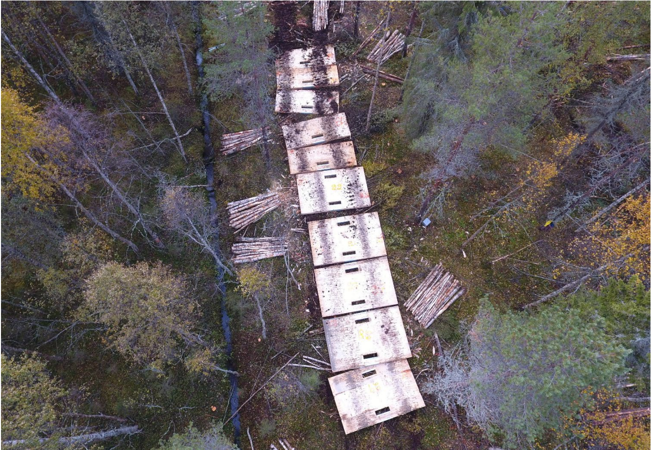
Kuva 1. CLT-levyt käytössä puunkorjuukohteella (Kuva Harri Lindeman)
