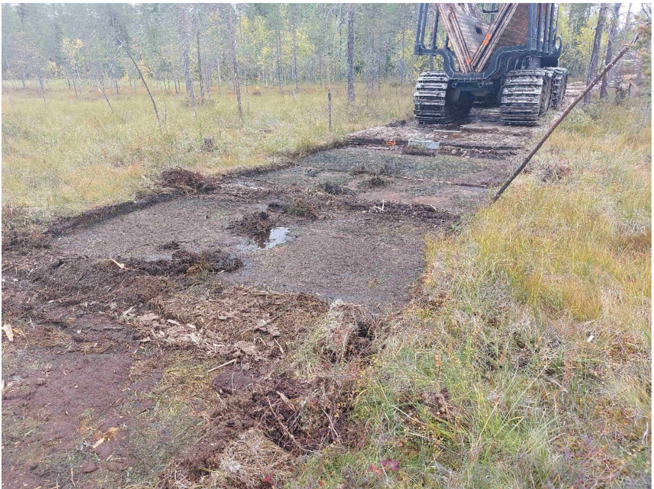
Kuva 5. CLT-levyjä käytettäessä turvemaan pintakerros puristuu ja tasoittuu. Kuvassa levyt olivat sijoitettuna paikoilleen noin kuukauden ajan. (Kuva Harri Lindeman)
