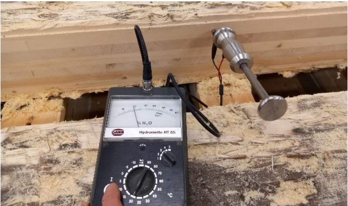
Kuva 4. CLT-levyjen puuaineen kosteus mitattiin ja kirjattiin taivutus- ja liimasauman leikkauslujuustestien lähtötiedoiksi. (Kuva Matti Yliniemi)
