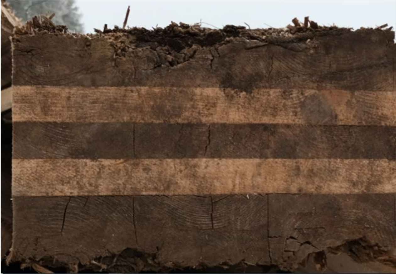
Kuva 7. Mitä paksumpia CLT-levyjen suojaavat pintakerrokset ovat, sitä enemmän levy kestää ajokertoja. (Kuva Matti Yliniemi)
