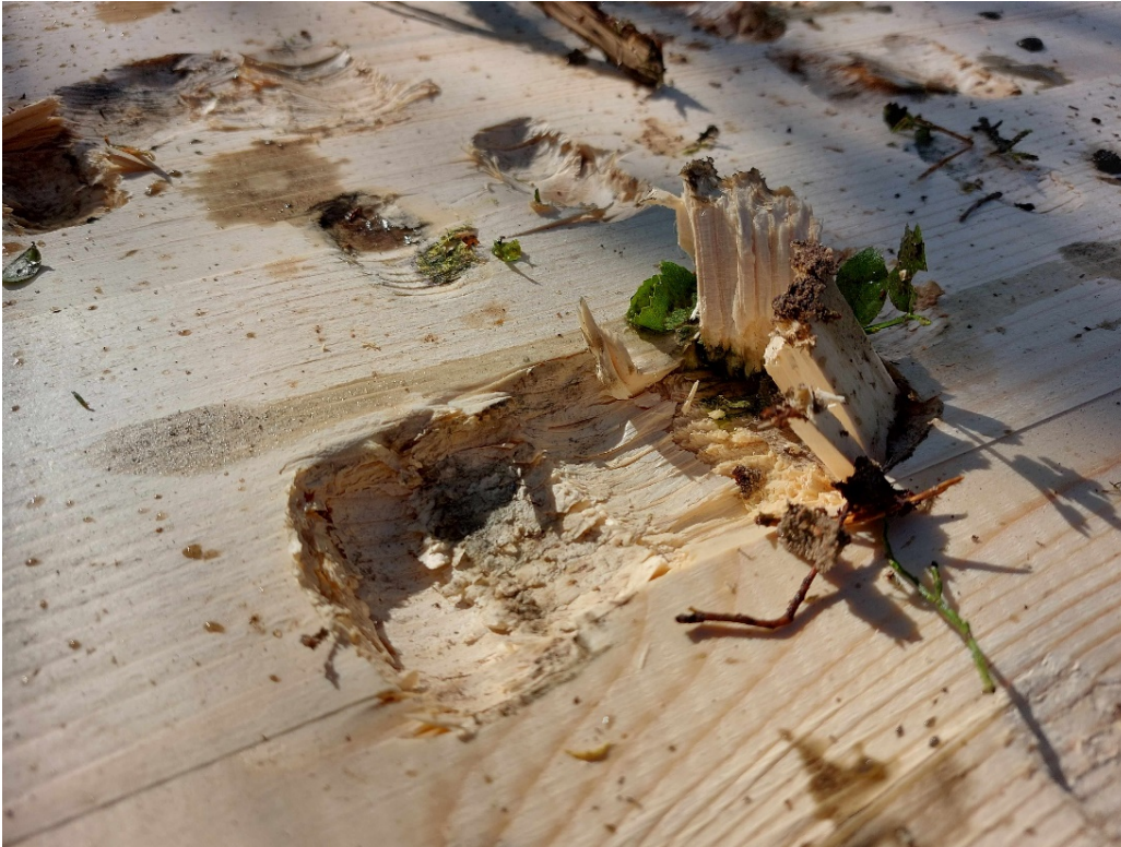
Kuva 4. Metsäkonetelan hokin jälki uudessa levyssä. Renkaiden ja telien varustelu vaikuttaa CLT-levyjen kulumiseen merkittävästi. (Kuva Harri Lindeman)
