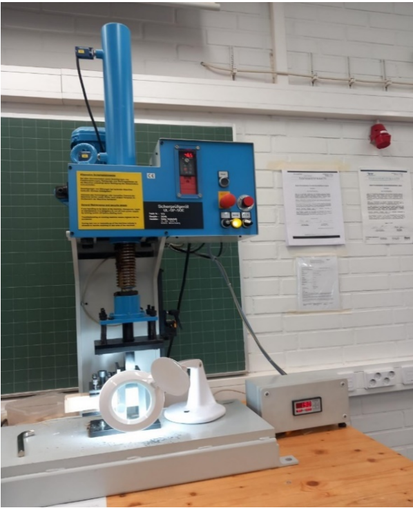
Kuva 2. Liimasauman leikkauslujuuden testilaite. (Kuva Matti Yliniemi)
