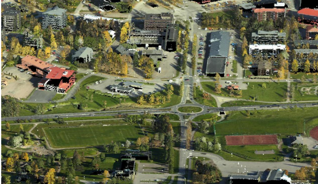
Kuva 34. Ylivieskan kaupungissa suoritetun laserkeilausaineiston värjääminen ilmakuvan pikselien väriarvoilla. Toiminto onnistuu myös Microstationin työkaluilla. [36]
