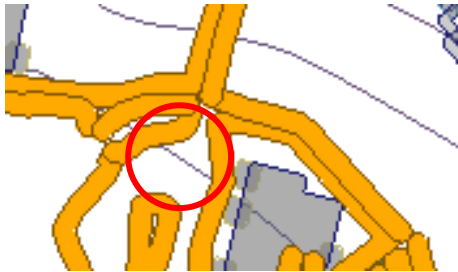
Kuva 19. Korkeuskäyrä kahden kevyenliikenteenväylän välissä, jonka ei olisi tarvinnut poistua (ympyröity punaisella).
