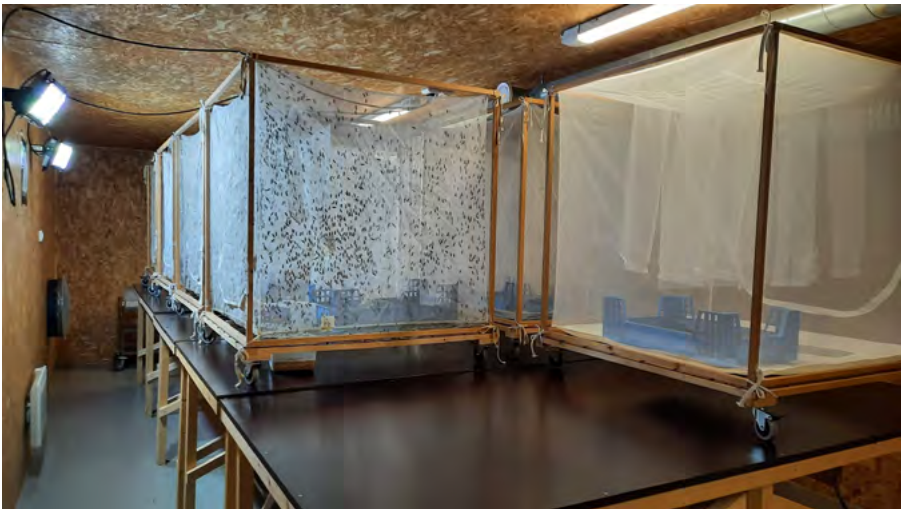
Kuva 1. Valohäkit sijoitettiin pöydille oikean työskentelykorkeuden saamiseksi. (Kuva: Henna Pitkänen)
