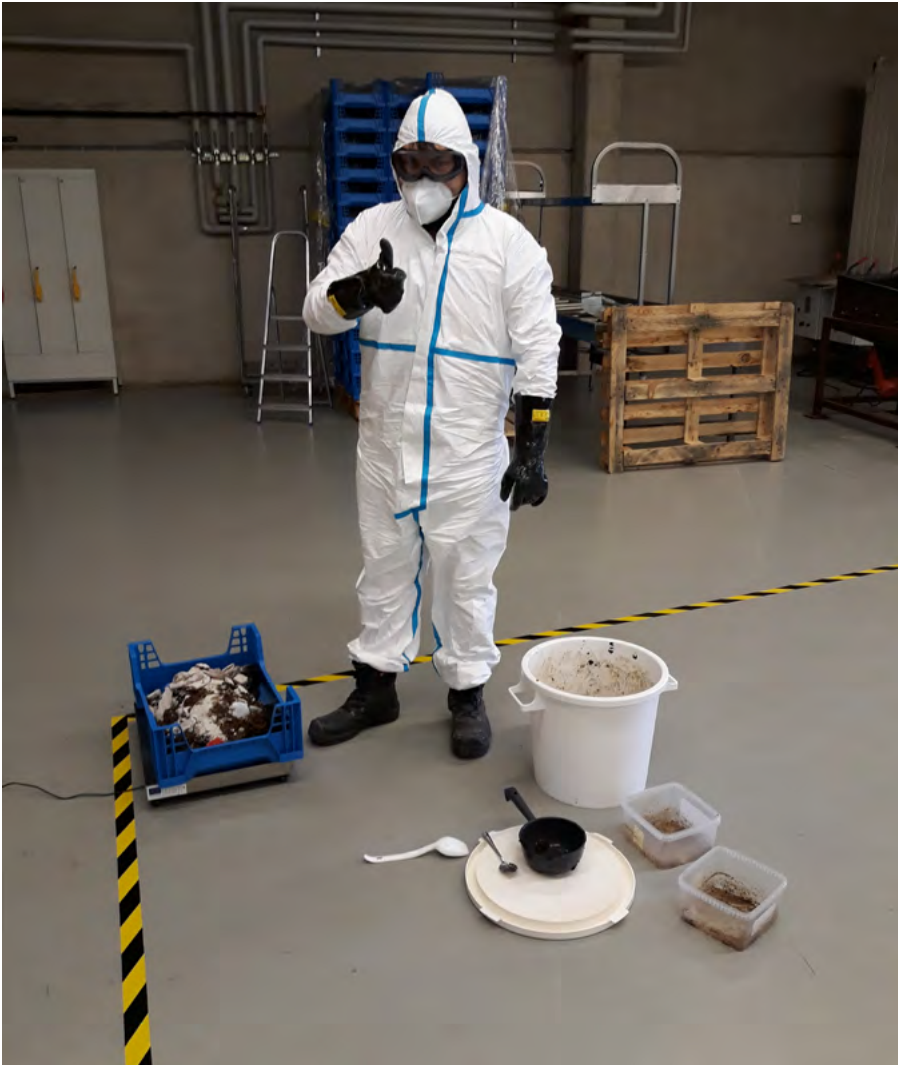
Kuva 1. Lietekoetta tehdessä työntekijät pukeutuivat suojahaalareihin, silmä- ja hengityssuojaimiin sekä käyttivät paksumpia kumikäsineitä. Lietekokeen ajan hallin ja kasvattamon likaiset alueet oli merkitty lattioihin huomioteipillä. (Kuva: Niina Koivisto)
