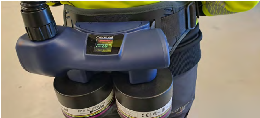
Kuva 3. Henkilönsuojaimen moottori ja suodattimet kiinnitettiin vyötärölle. (Kuva: Maiju Kurtti)
