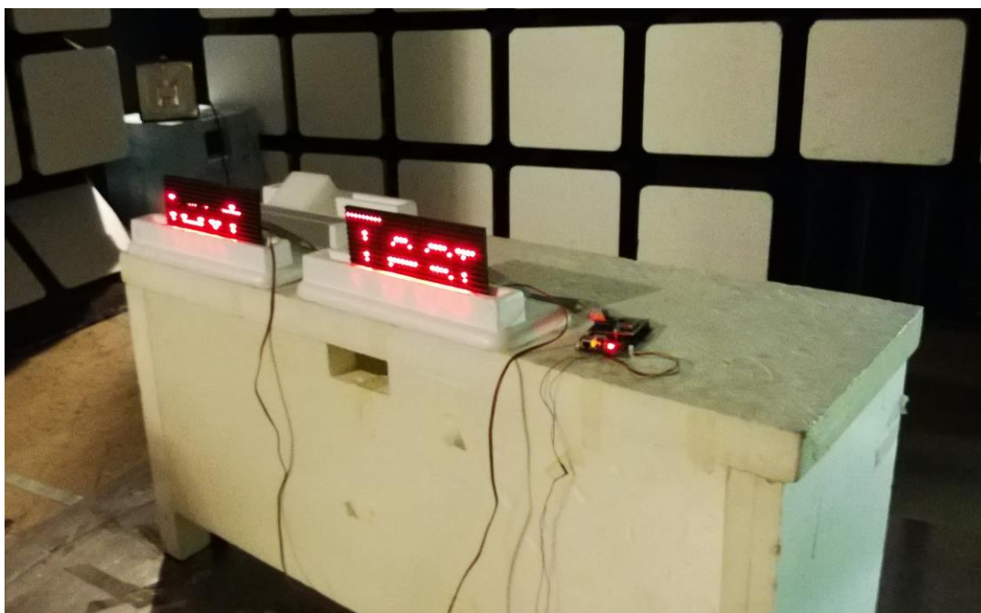
KUVA 4. Ohjainkortin ja kahden näyttömoduulin kokoonpano EMC-testeissä (Valokuva Pauli Tervonen.)
