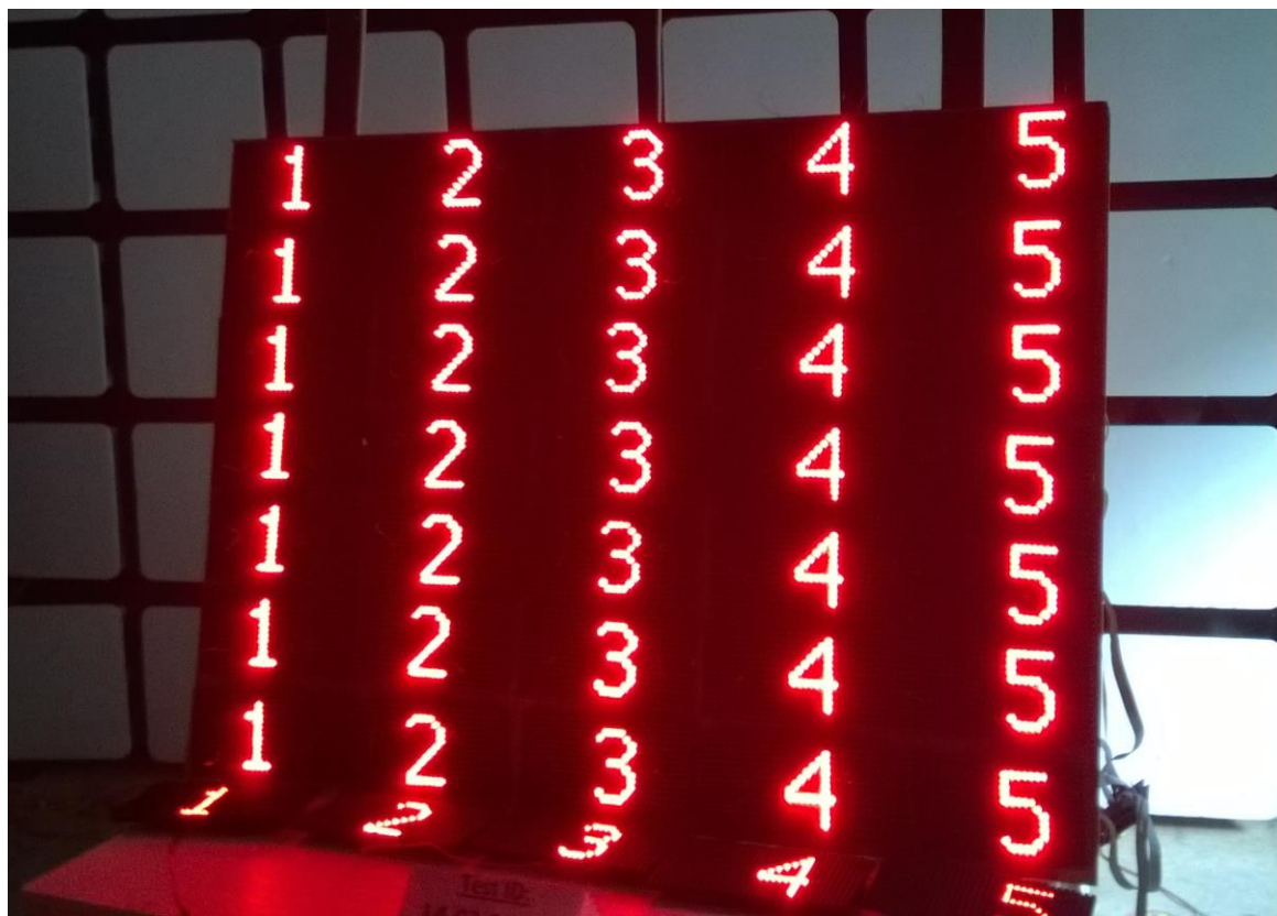
KUVA 5. Ohjainkortin ja 40 näyttömoduulin kokoonpano EMC-testeissä (Valokuva Pauli Tervonen.)
