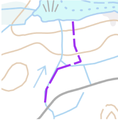
Kuva 44. Veden kulkureitti maastossa menee eri tavalla kuin kartta antaa ymmärtää (© Maanmittauslaitos 2023a).
