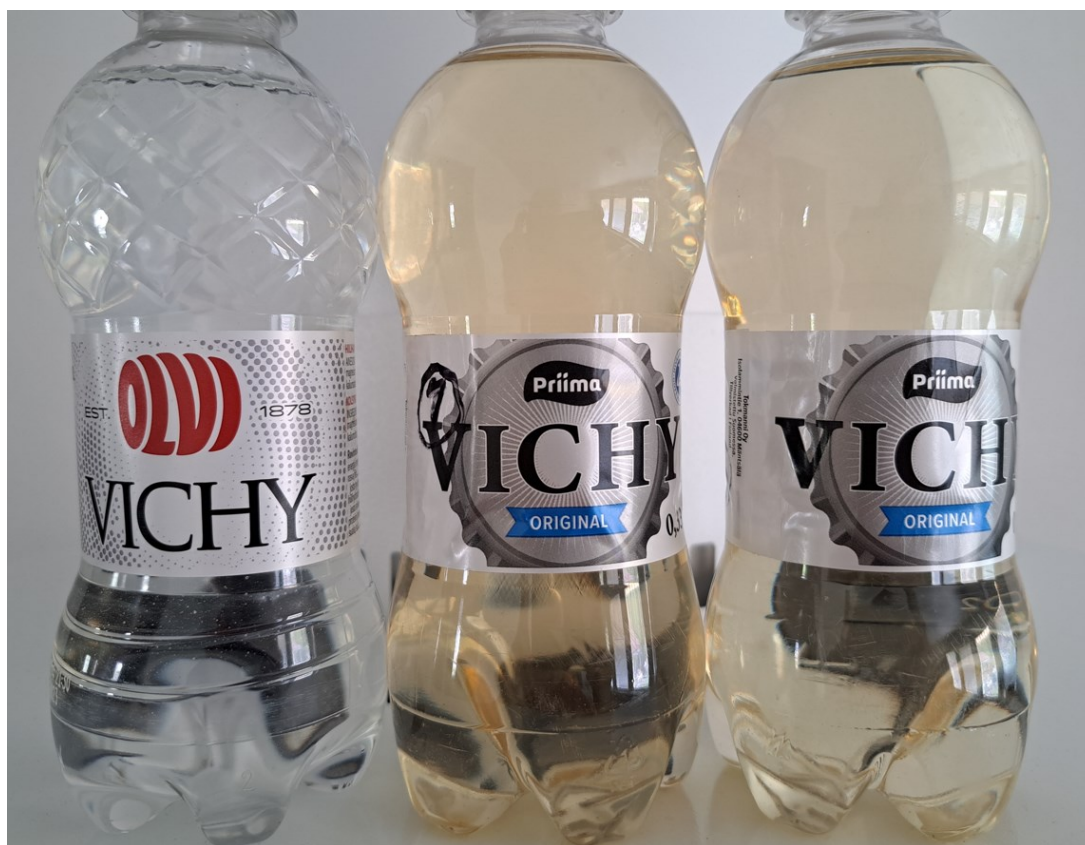
Kuva 123. Vasemmalla vesijohtovettä referenssinä. Keskellä näyte kohdasta 1, joka on valuma-alueen loppupäästä, Myllypuron suulta. Oikealla näyte kohdasta 4, joka on valuma-alueen alkupäästä, Hiekkajärven läheltä.
