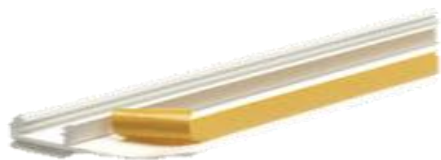
Kuva 6. Ikkuna-aukon rappauslista, suojamuovi kiinnitetään ulokkeeseen ruskean teipin suojapaperin tilalle, uloke irrotetaan suojamuovien poiston yhteydessä. evuorio.fi luettu 2.9.2014.
