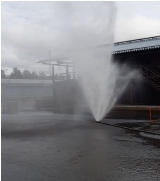
Kuva 12. Pienemmän sammutinkärjen vesikuvio, paine ja virtauslukema maksimipaineella.
