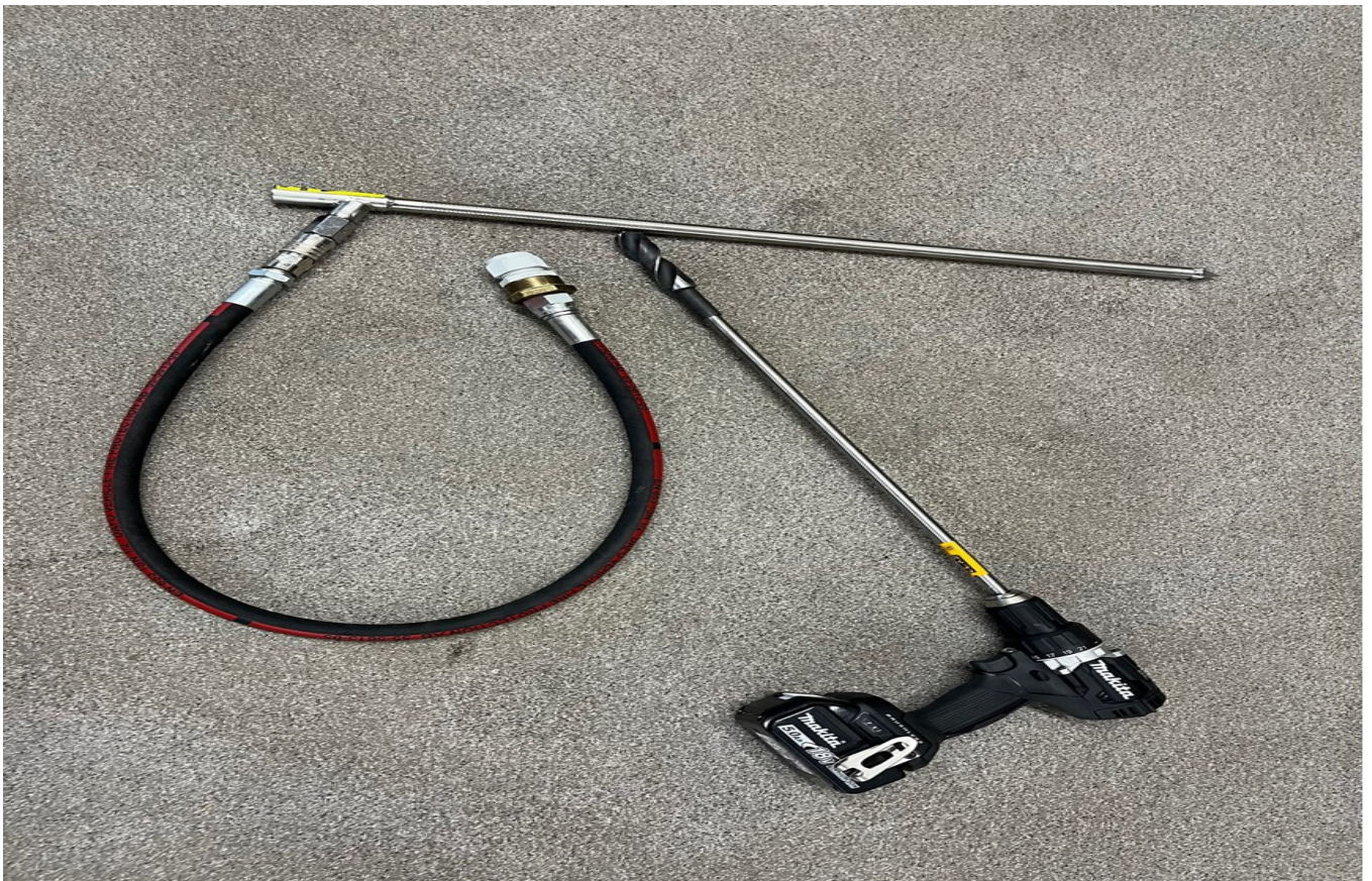
Kuva 25. Jauhesammuttimeen liitettävä pistosuihkuputki ja reiän poraustarvikkeet.
