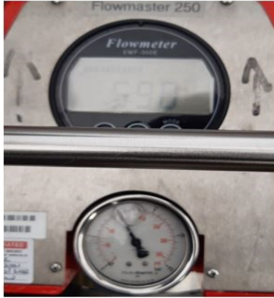
Kuva 12. Pienemmän sammutinkärjen vesikuvio, paine ja virtauslukema maksimipaineella.
