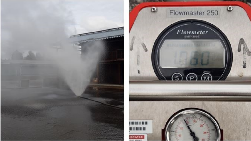
Kuva 14. Isomman sammutinkärjen vesikuvio, paine ja virtauslukema maksimipaineella.
