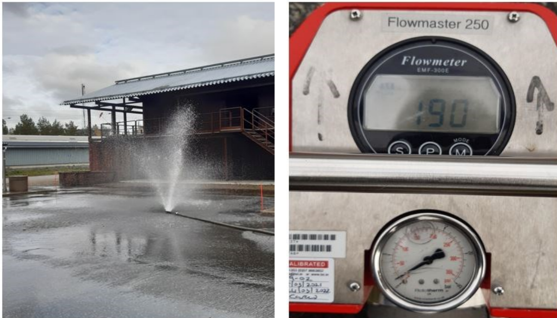
Kuva 11. Pienemmän sammutinkärjen vesikuvio, paine ja virtauslukema minimipaineella.
