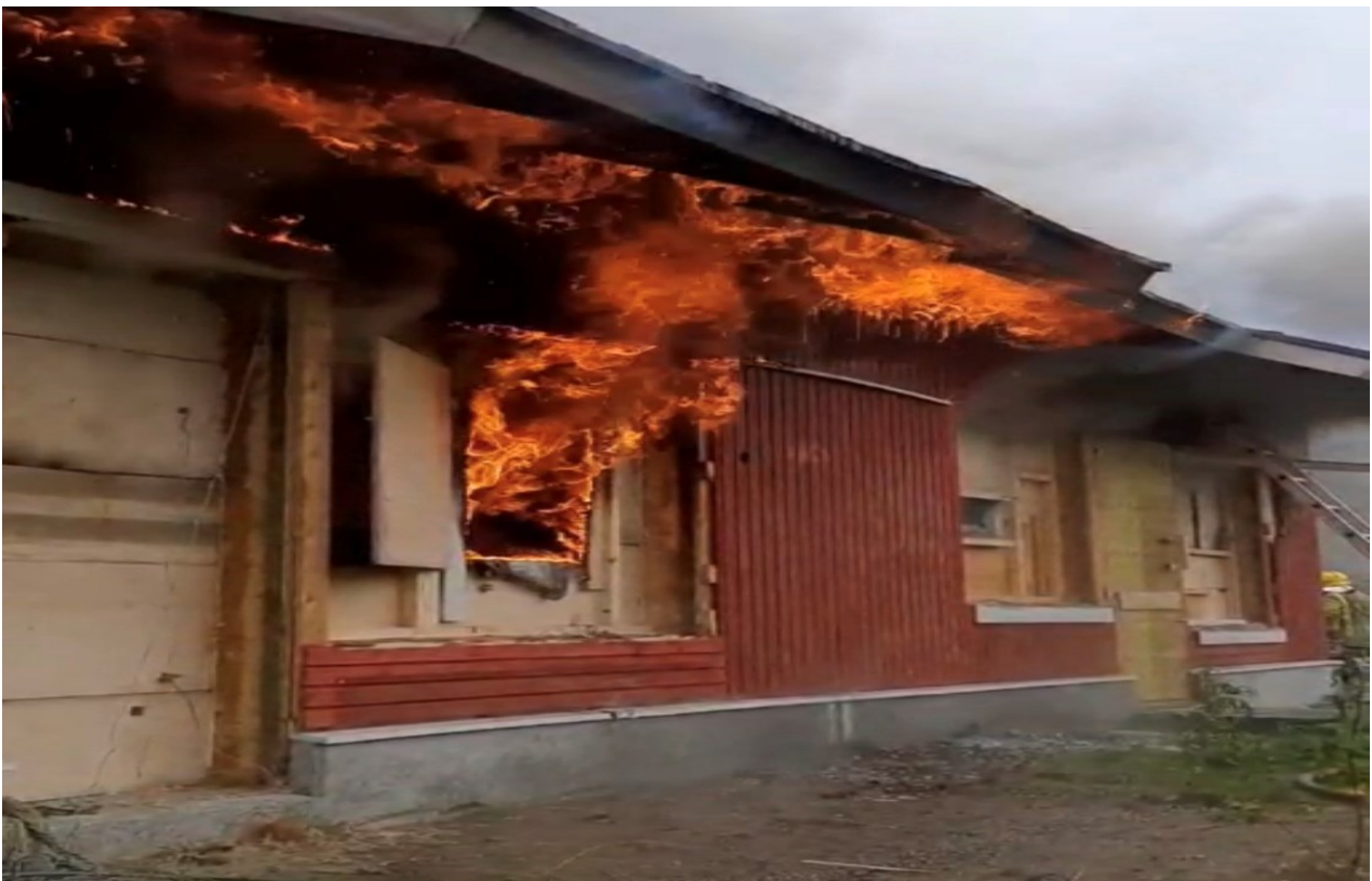
Kuva 16. Tilanne takaikkunalla, kun varsisammutin on ollut auki 10 sekuntia, tässä kohtaa vedentulo katkaistiin.
