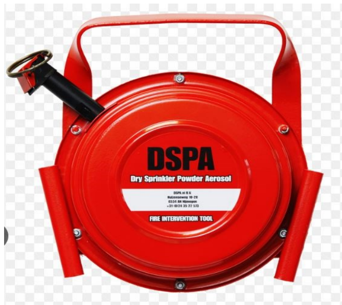
Kuva 6. DSPA-heittosammutin, jossa sammutetta 2300–3700 g. Sammutettavan tilan maksimi koko 110–180 m 3 . Purkautumisaika 25–30 sekuntia.
