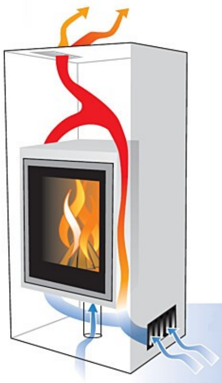
Kuva 7. Varaavan kiertoilmatakan toimintaperiaate [37].
