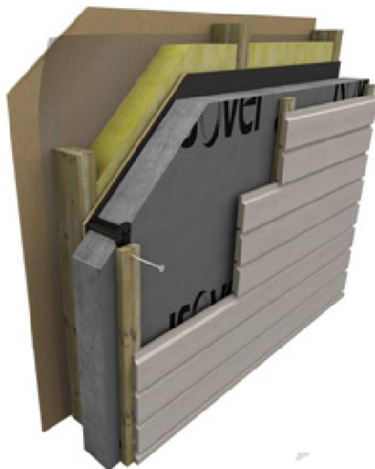
Kuva 9. Vanhan villaeristetyn ulkoseinän lisäeristäminen ulkopuolelta [46, s. 2].
