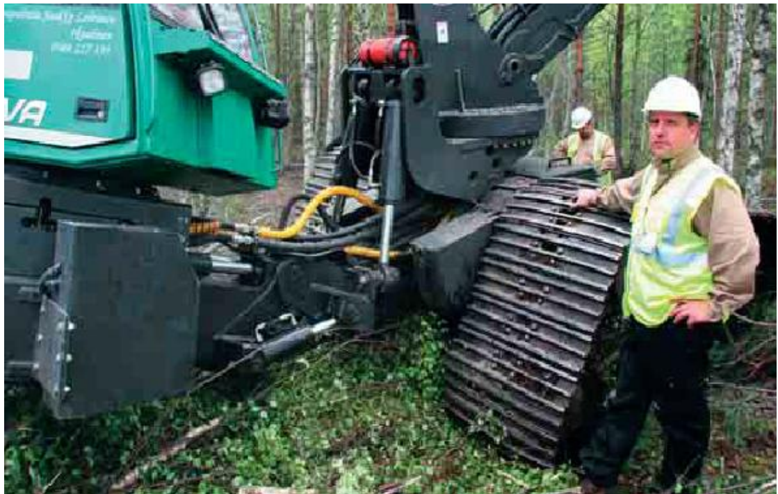
KUVA 5. Saranarunkoinen Pro Silva 910 harvesteri suotelastolla (Kärhä 2012)
