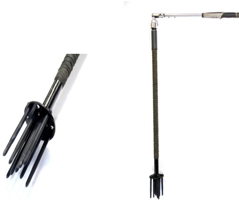
KUVA 11. Piikkisiipikairan pyörintävastus antaa tiedon maaperän kantavuudesta (Ala-Ilomäki Asikainen ym. 2013)
