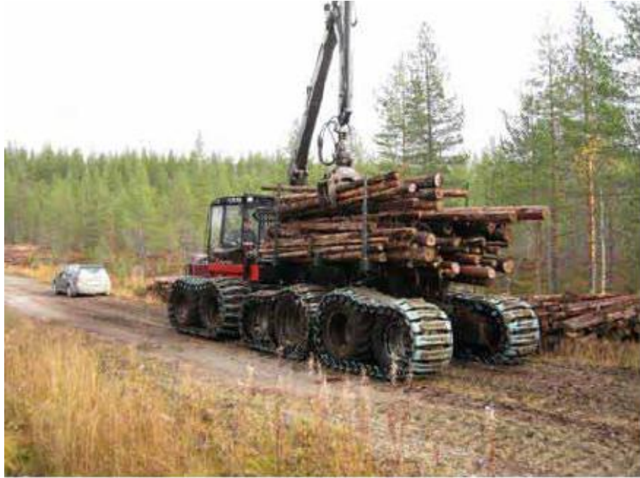
KUVA 8. Sakari Monosen kehittämä ratkaisu suomaiden puunkorjuuseen (Kumpare & Saarimäki 2009)
