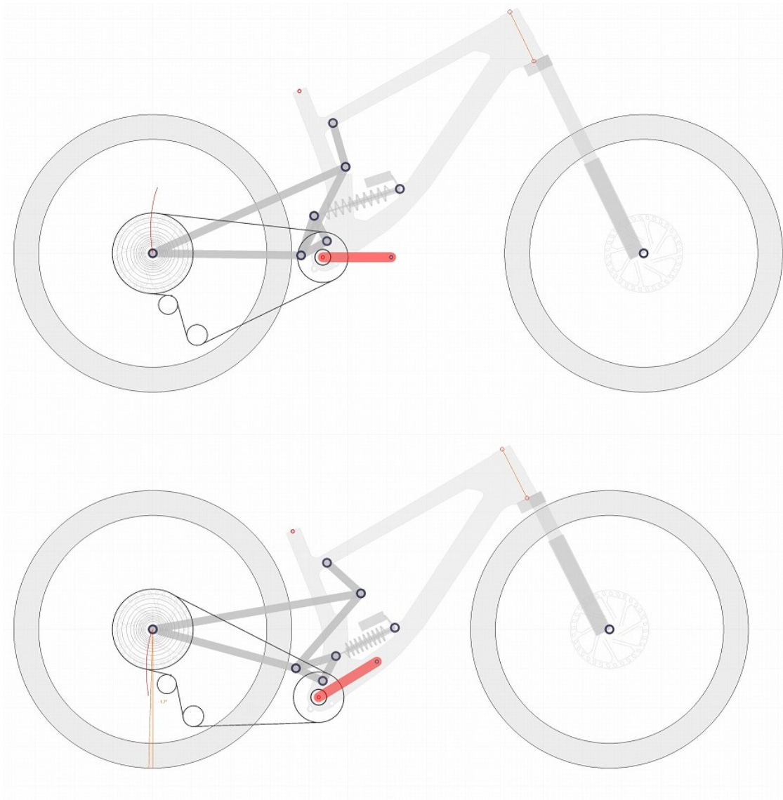
Kuva 14. Pedal kickback staattisessa ja maksimikuormituksessa.
