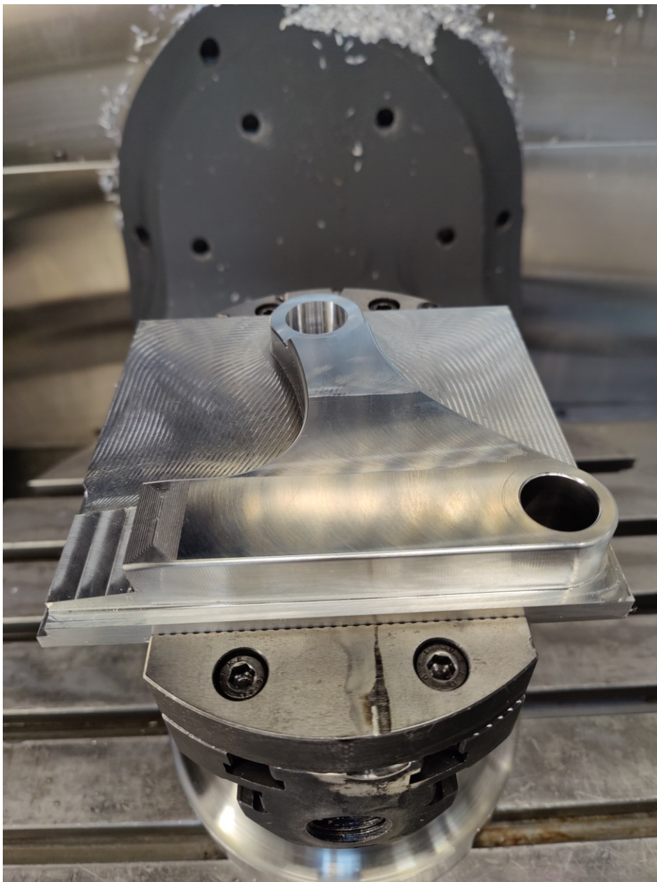
Kuva 57. Dropout_D:n ensimmäinen koneistusoperaatio.
