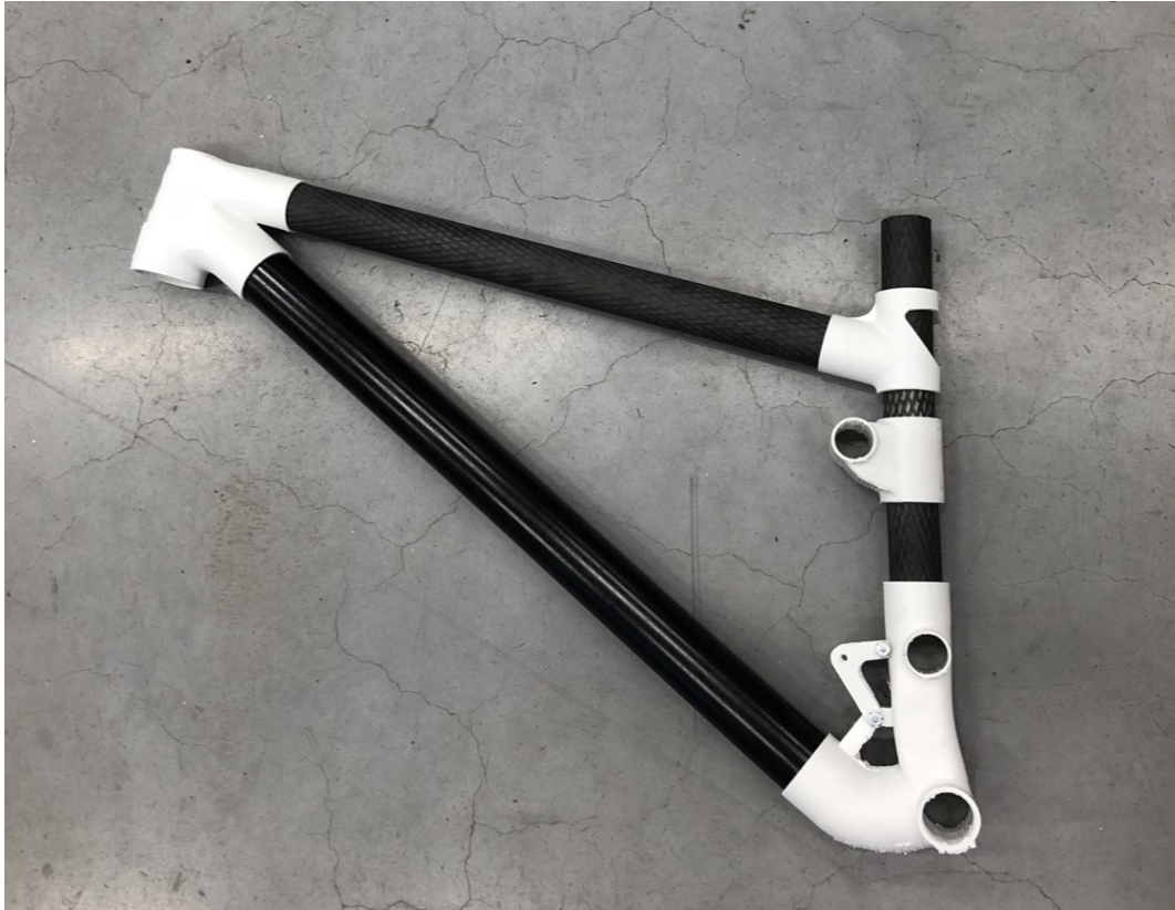
Kuva 39. Rungon eri komponenttien yhteensopivuudesta muoviprototyypitulos-teilla.
