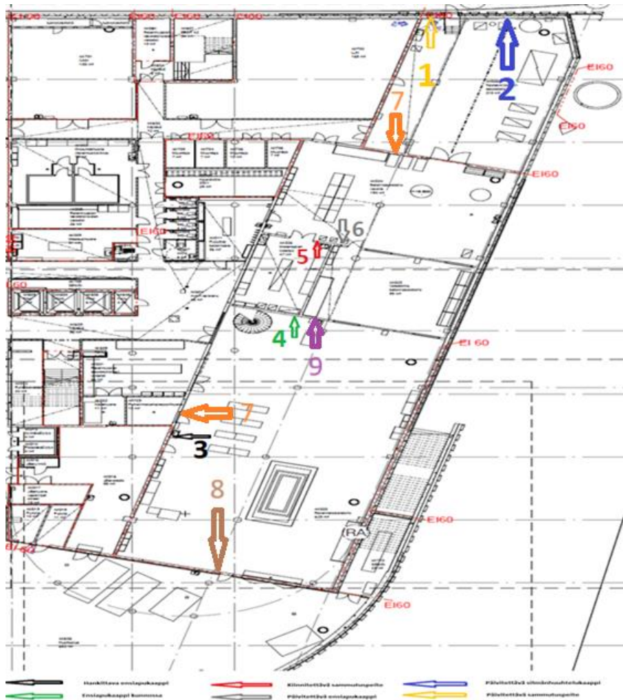
Kuva 5. Rakennustekniikan laboratorion ensiapukaappien, palopostikaappien, salosammuttimien sekä sammutuspeitteen sijoitus ja kunto (Hussein Mustapha 2023)
