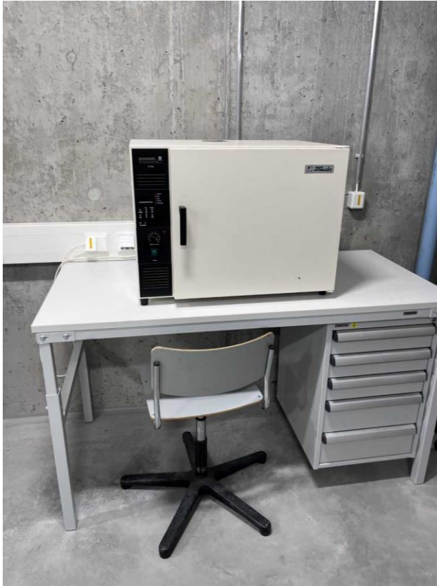
Kuva 12. Lämpökaappi (Rakennustekniikan laboratorio 2023)
