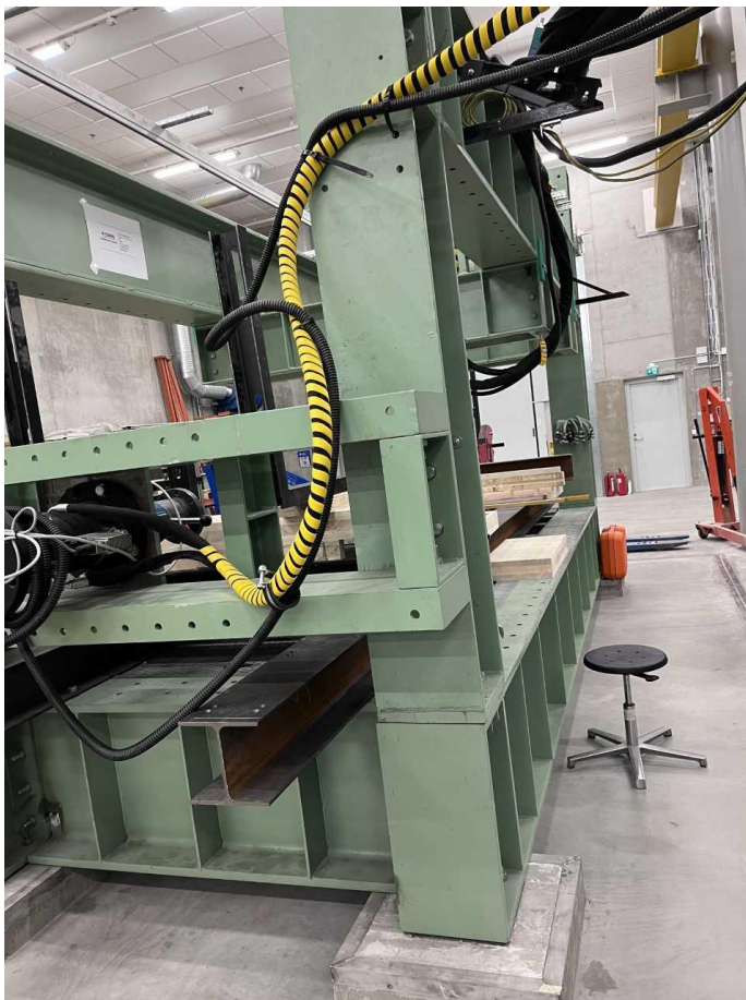
Kuva 10. Rakennustekniikan laboratoriotilan kuormituskehä
