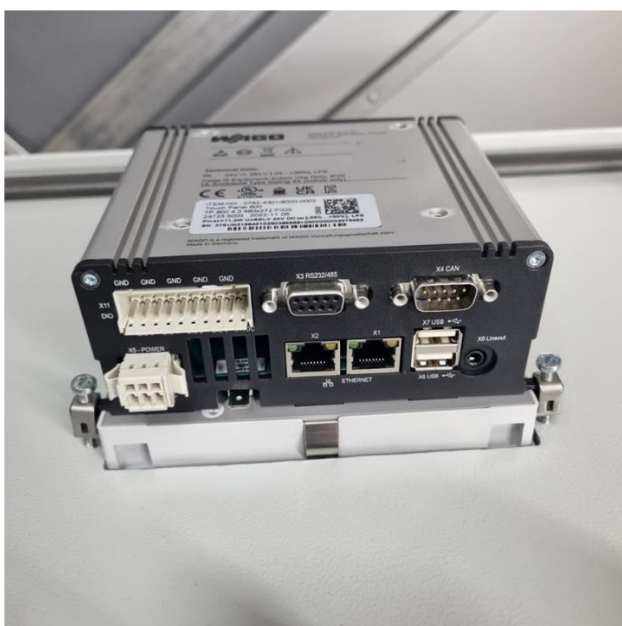
KUVA 5. Paneeli-PC asennettuna puristuselementeillä
