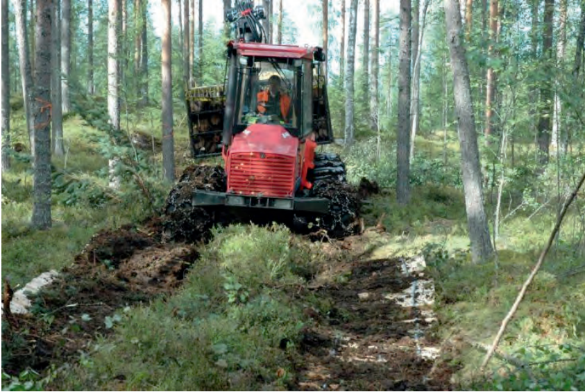
KUVA 21. Pitkospuumatto I testeissä. (Kuva Kati Kontinen).
