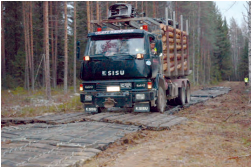
KUVA 11. Puutavara-auto kumimattojen päällä. (Kuva: Kati Kontinen)
