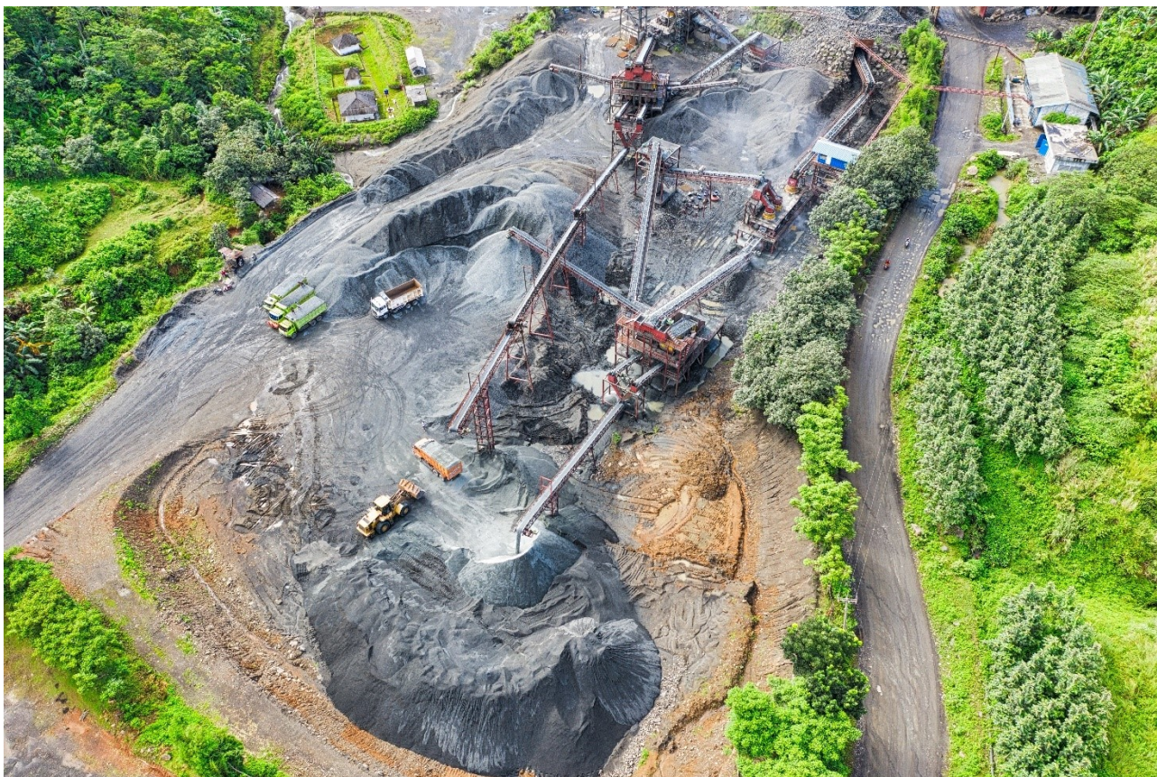
Kuva 4. Esimurskauksen jälkeinen hienonnuks linjasto (Fisk, 2019).
