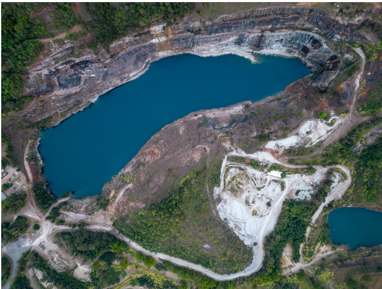
Kuva 9. Suljettu avolouhos täyttynyt vedellä (Oliveira, 2023).
