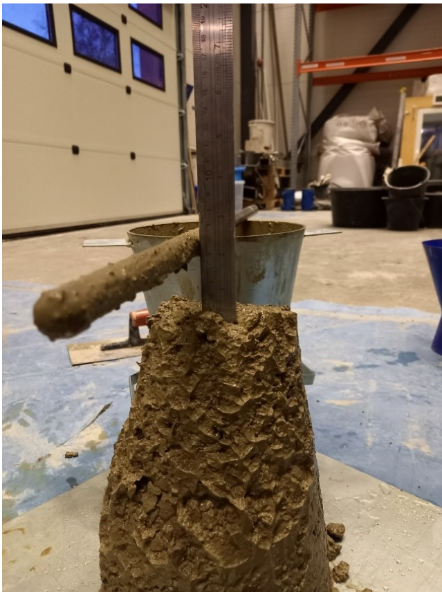
Kuva 8 Kartiokokeella testattu betonin notkeus.
