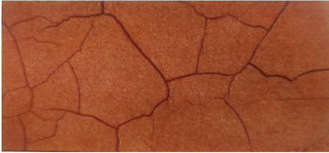
Kuva 14. Haljennut maali pinta. (Caridis, 2009, s. 232)
