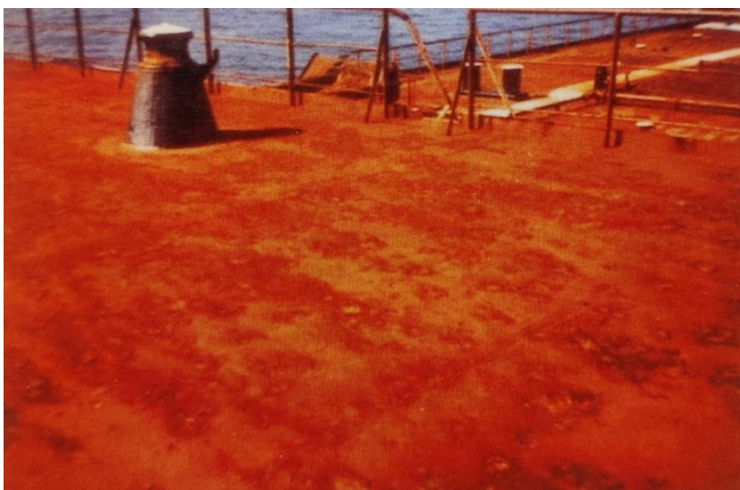
Kuva 2. Yleinen korroosio laivan kannella. (Caridis, 2009, s. 2)
