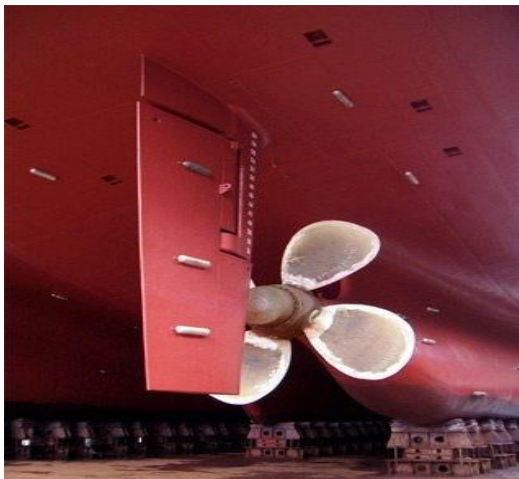
Kuva 16. Uhri anodeja laivan rungossa. (My Electrical Engineering, 2013)
