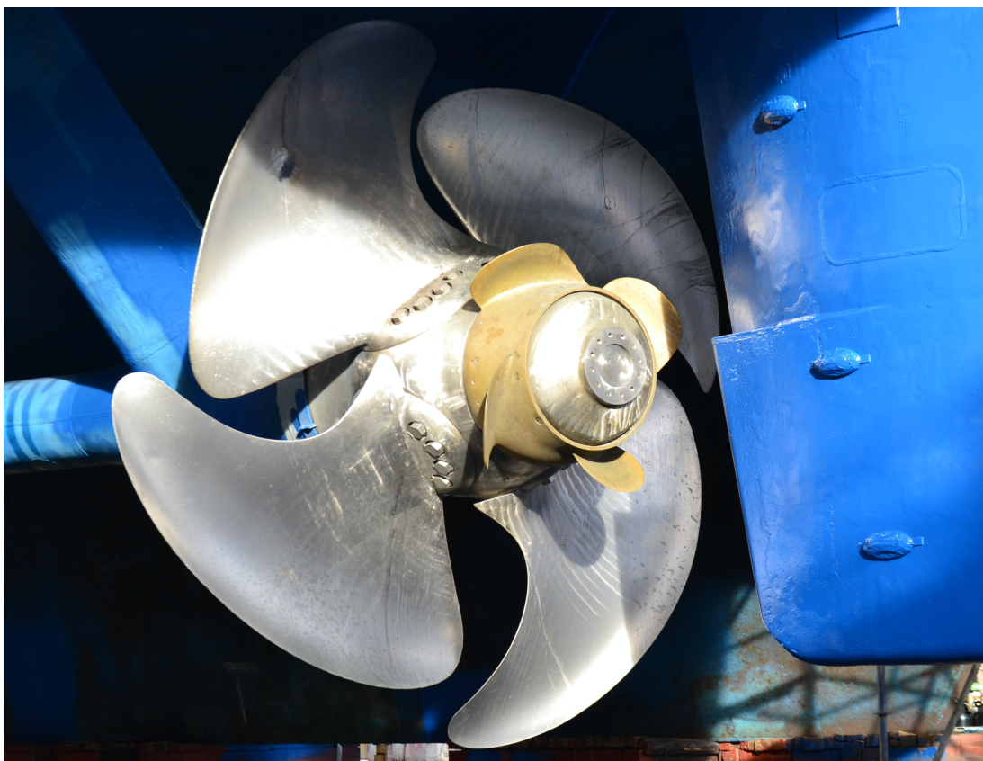
KUVA 7. Wärtsilä EnergoProFin lisäpotkuri ja Becker peräsin. (A. Österman, 2023)
