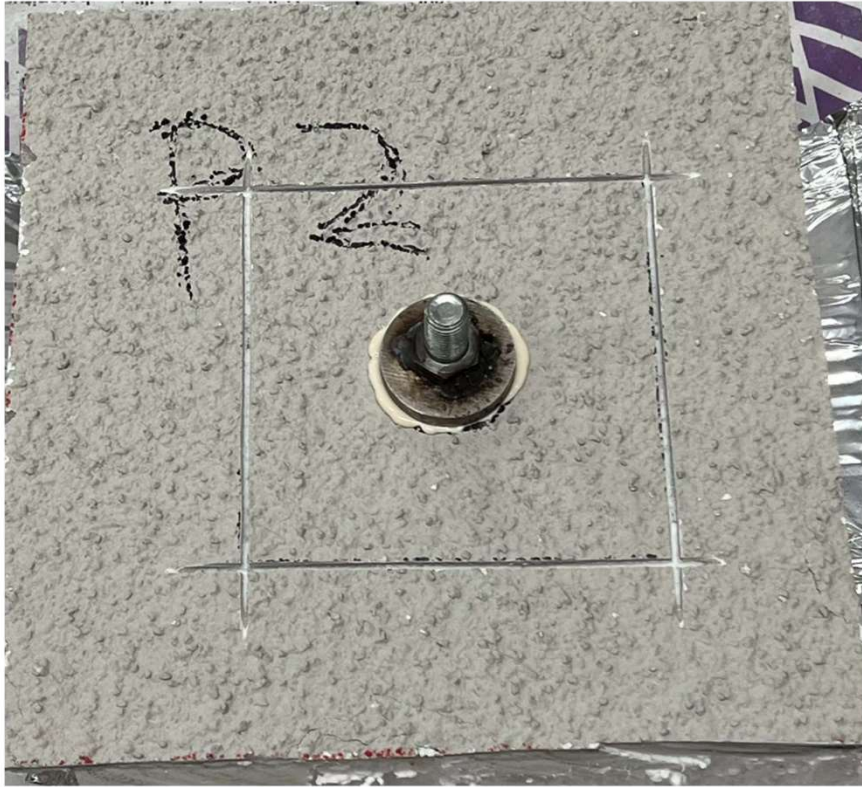
Kuva 6. Koepalaan liimattu teräslätkä
