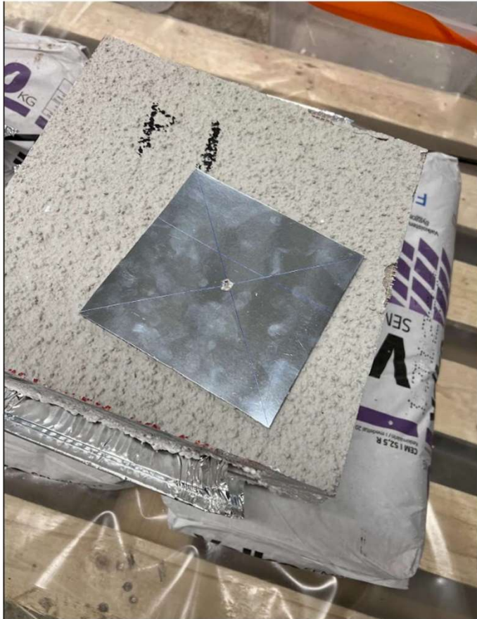
Kuva 3. Koepalojen urituksessa käytetty 150 x 150 mm sapluuna.
