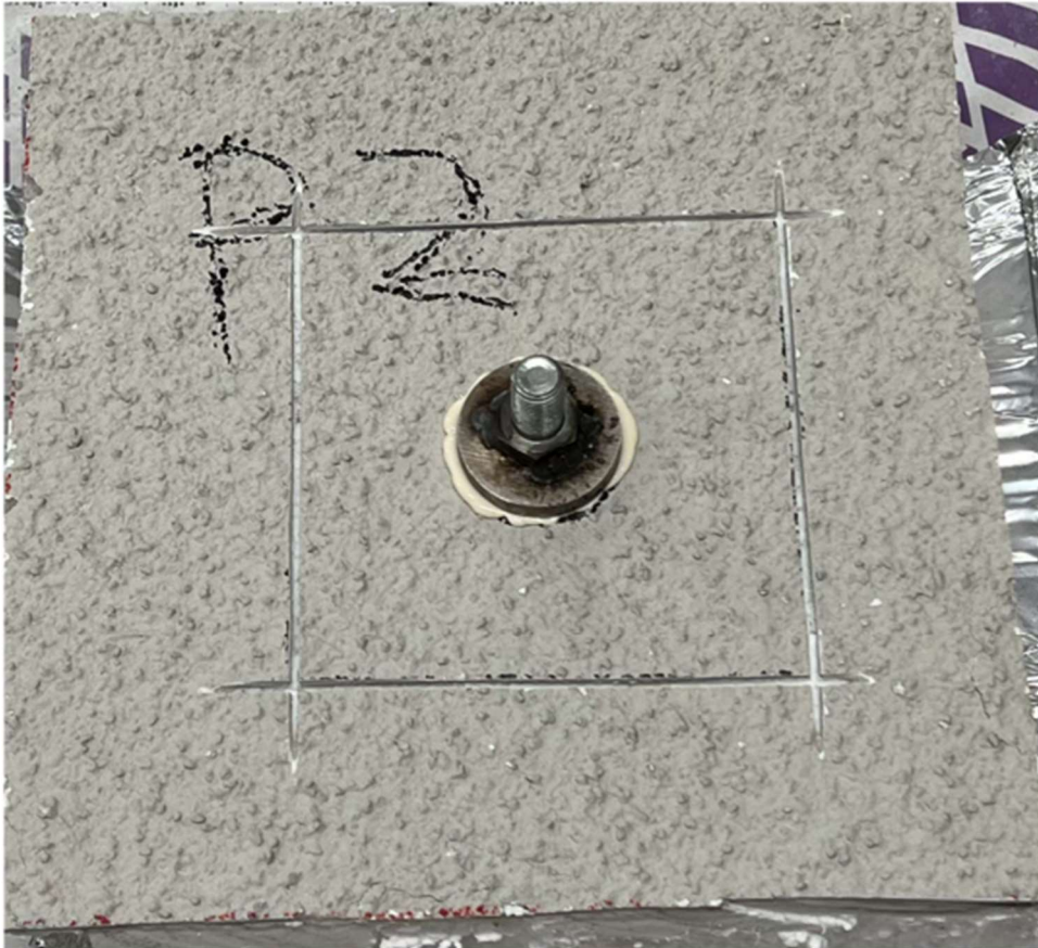
Kuva 6. Koepalaan liimattu teräslätkä
