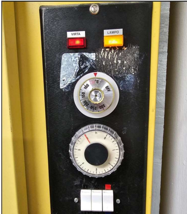
Kuva 2. Uuniin asetettu lämpötila koepalojen kuivatukselle
