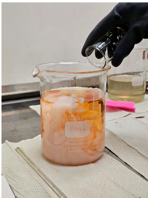
KUVA 7. Kankaan suodattamisen jälkeen jääneen liuoksen saostaminen rikkihappoa lisäämällä (kuva Anne Gango).
