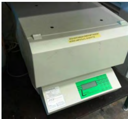
KUVA 4. FOX304-lämpövirtalevyllä (kuva Tampereen yliopisto) ja toimintaperiaate (kuva Tiina Ruuska).
