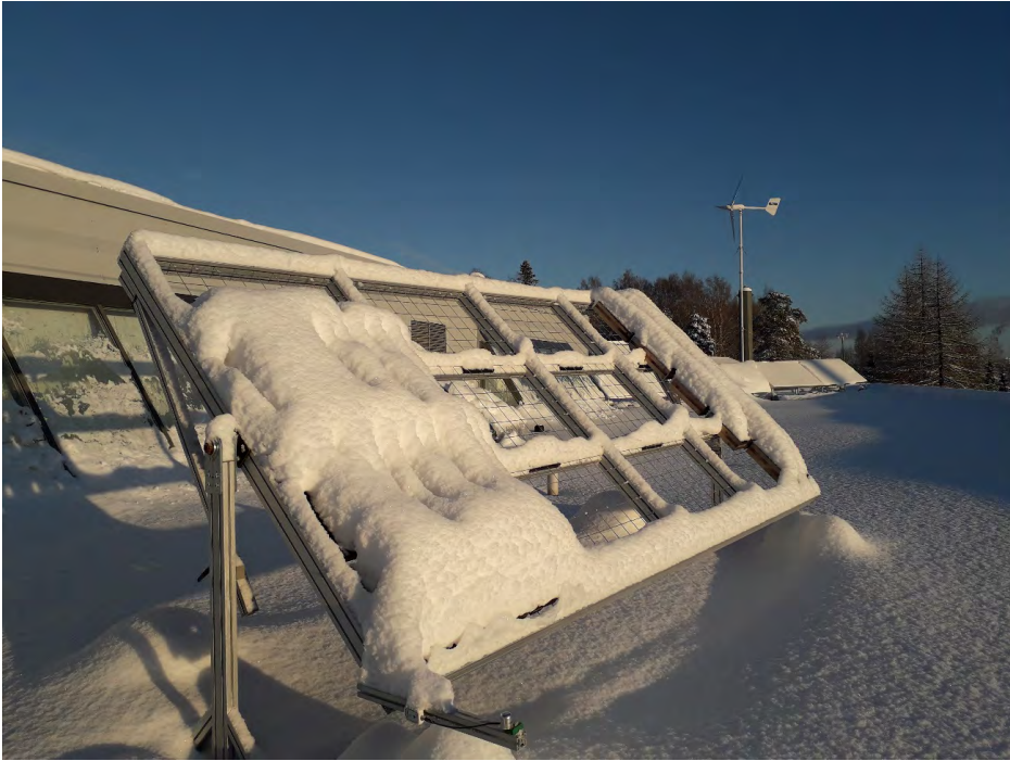
KUVA 4. Esimerkki luonnollisen säärasituksen testiolosuhteista Suomessa. Pintahiililettyjä koekappaleita Mikkelin testikentällä talvella 2022. (kuva Hannu Turunen)
