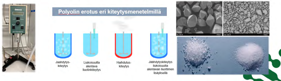
KUVA 3. Aalto-yliopiston ksylitolin talteenottokokeissa käyttämät kiteytysmenetelmät: jäähdytys- ja haihdutuskiteytys sekä liukoisuutta alentava liuotinkiteytys sekä jäähdytyskiteytyksen ja liukoisuutta alentavan liuotinkiteytyksen yhdistelmä (kuva mukailten Aalto-yliopisto IMPRESS-utiskirje #6 2023).
