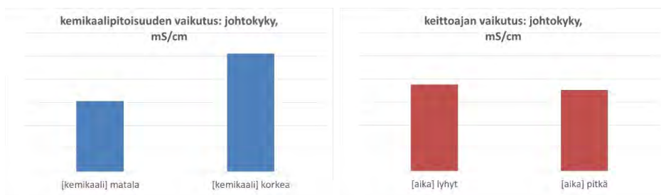
KUVA 7. Kemikaalipitoisuuden ja keittoajan vaikutus keiton lopussa talteen otetun keittoliemen johtokykyyn (kuva Juhana Pakkasmaa).
