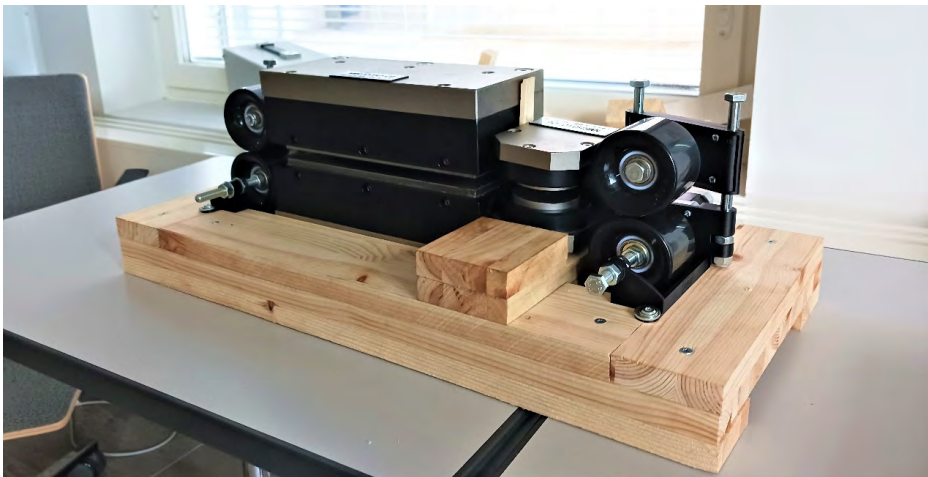
KUVA 4. Mittausjärjestelmän prototyypin viulun liikutusjärjestelmä on korvattu 3D-tulostetuilla osilla (kuva Jere Järvenpää 2023).
