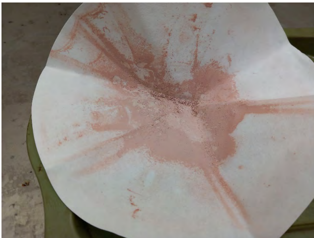
KUVA 5. Vaaleanpunertava huoneenkosteuteen kuivunut saostuma eli kiinteä aines koetta seuraavana aamuna vetokaapissa (kuva Eveliina Kuokkanen).
