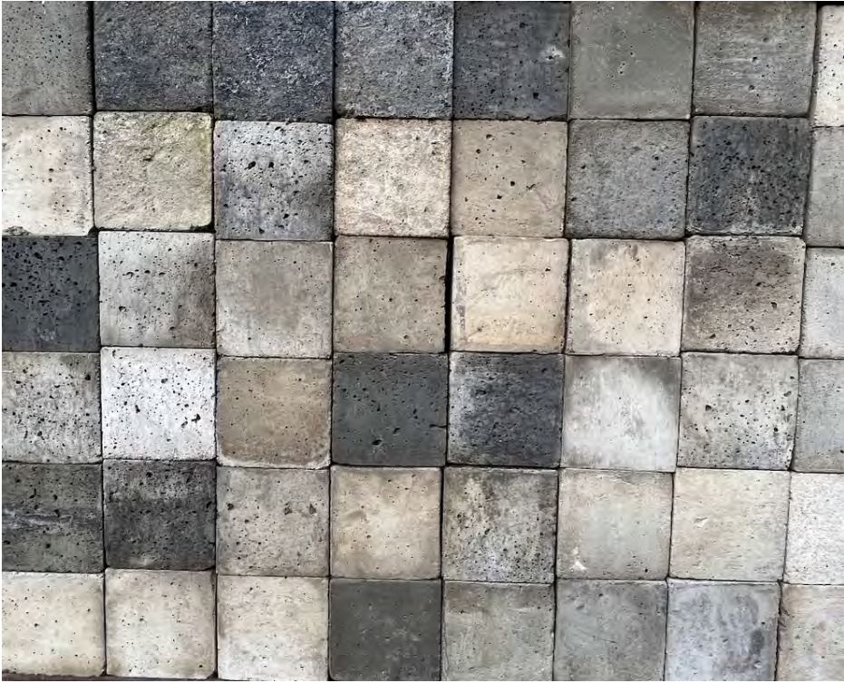
KUVA 2. Hankkeessa valmistettiin paljon erilaisia koekappaleita laboratorio- ja pilot-mittakaavan kokeisiin. Koekappaleiden biohiilen ja sementin seossuhde vaihteli. Biohiili antaa koekappaleelle tummemman värin verrattuna normaaliin betoniin. (Kuva Anna Dunderfelt)
