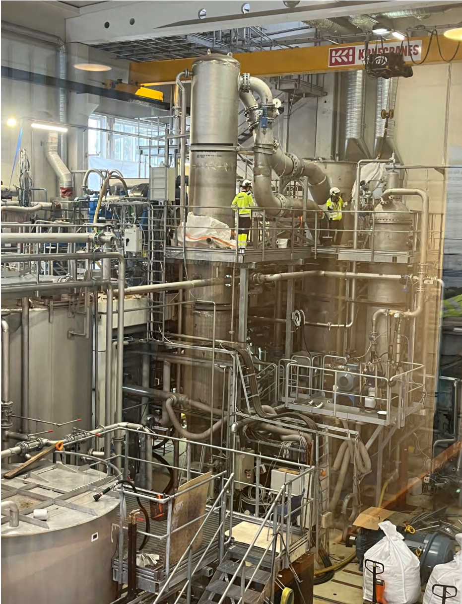
KUVA 1. Xamk Kuitulaboratorion uusi teollisen mittakaavan MC-tutkimusympäristö sekä sen vieressä oleva paineellinen reaktori, jolla voidaan tutkia uusien sellulaatujen sekä esimerkiksi kierrätystekstiilin kemiallista käsittelyä teollisessa mittakaavassa (kuva Lasse Pulkkinen).
