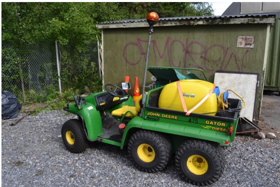
Kuva 4. Lavamaasturi, John Deere varustettuna kasvinsuojeluruiskulla.
