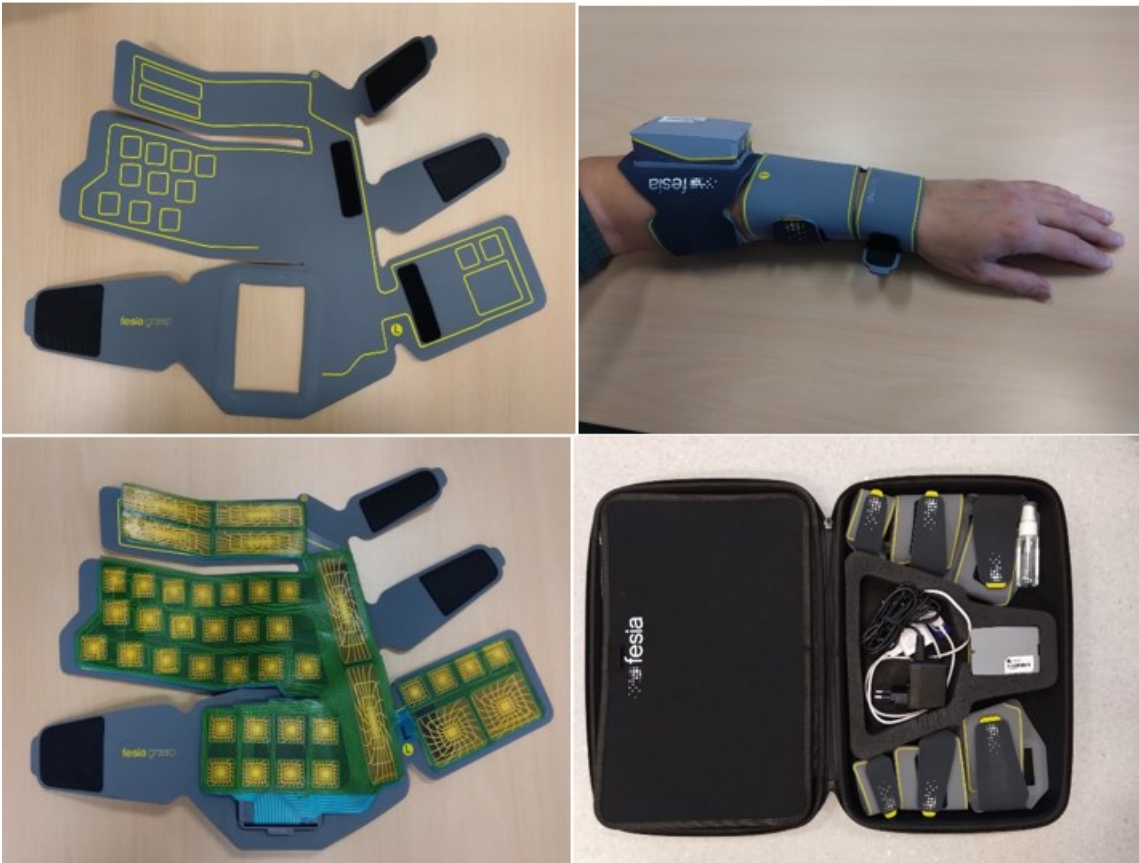
Kuvio 1 Fesic Grasp laitteen kuvia mansetista, elektrodeista, säilytyslaukusta ja laitteesta kuntoutujan kädessä (Nousiainen 2023)
