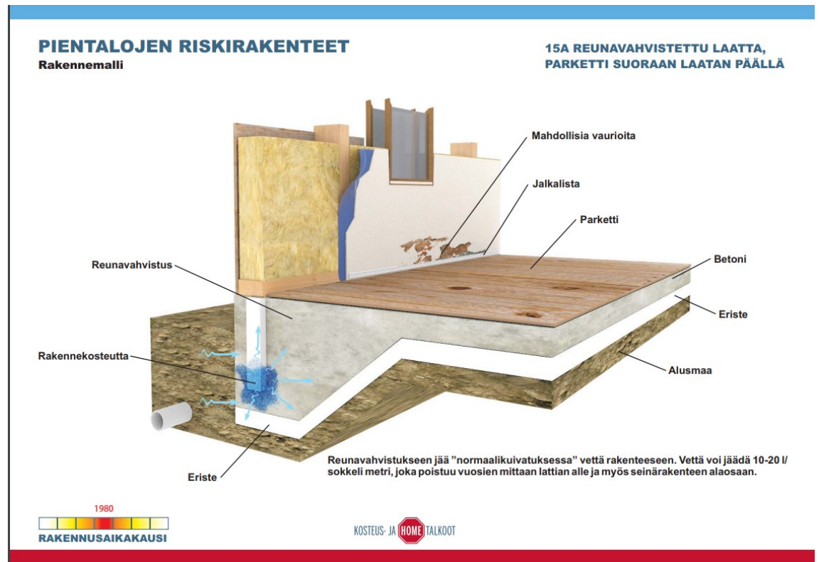
KUVA 11. Reunavahvistettu laatta, jossa parketti on suoraan laatan päällä (Kosteus – ja hometalkoot 2012, 58).
