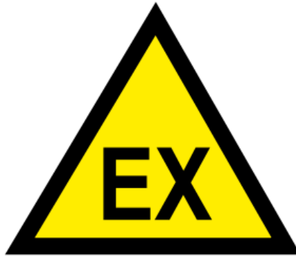
Figure 25. Warning sign that indicates explosive atmosphere. (Turvallisuus ja kemikaalivirasto, 2015, p. 16)
