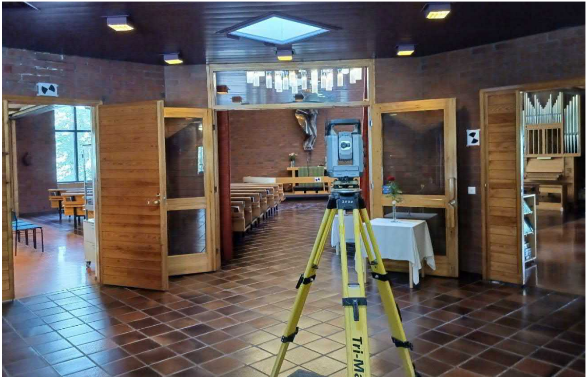
Kuvio 37. Takymetrillä tähysten mittaus rakennuksen sisäosien laserkeilausta tukien
