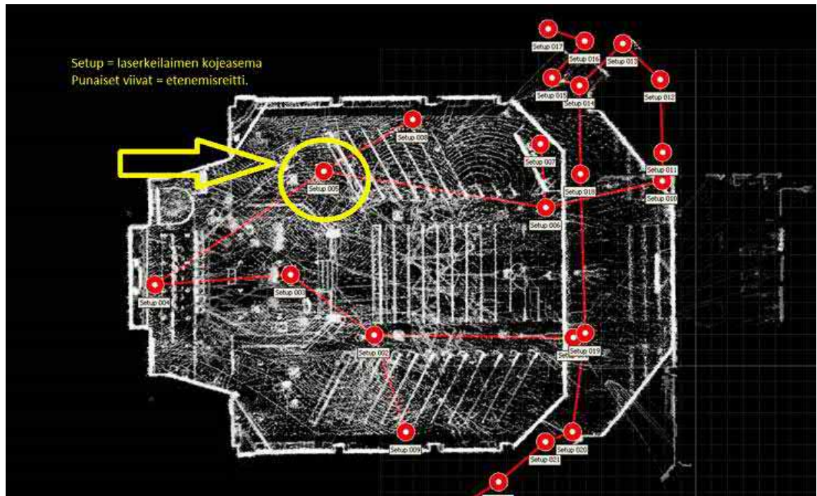
Kuvio 38. Keilauksen eteneminen (Leica Geosystems 2023b)
