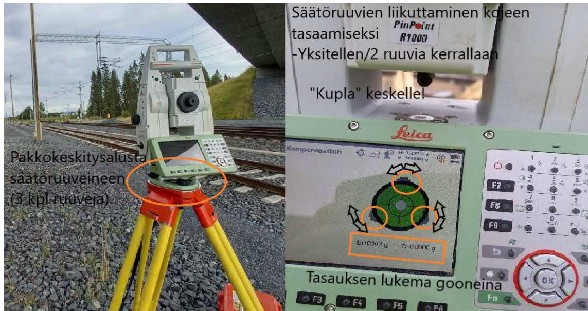
Kuvio 8. Takymetrin pakkokeskitysalustan tsaus paikalleen mahdollisimman tsaaisesti
