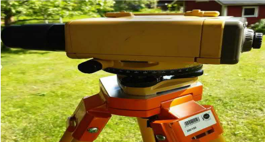
Kuvio 12. Topconin digitaalinen vaaituskoje Topcon DL-100 sarjasta (Tampereen Infra Instagram 2023a)
