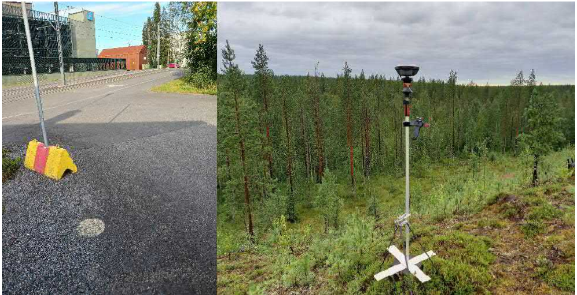
Kuvio 33. Signaaleita ilmakuvauksia varten: Tampereen Infran dronekeilausten tähys (vasemmalla), ristitähyksen mittaus GNSS-mittauksella lentokoneella tehtävää ilmakeilausta varten (oikealla)
