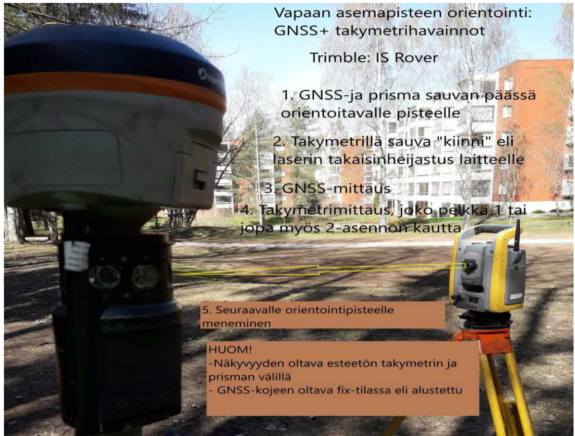
Kuvio 9. Vapaan asemapisteen menetelmän orientointi GNSS -mittauksena
