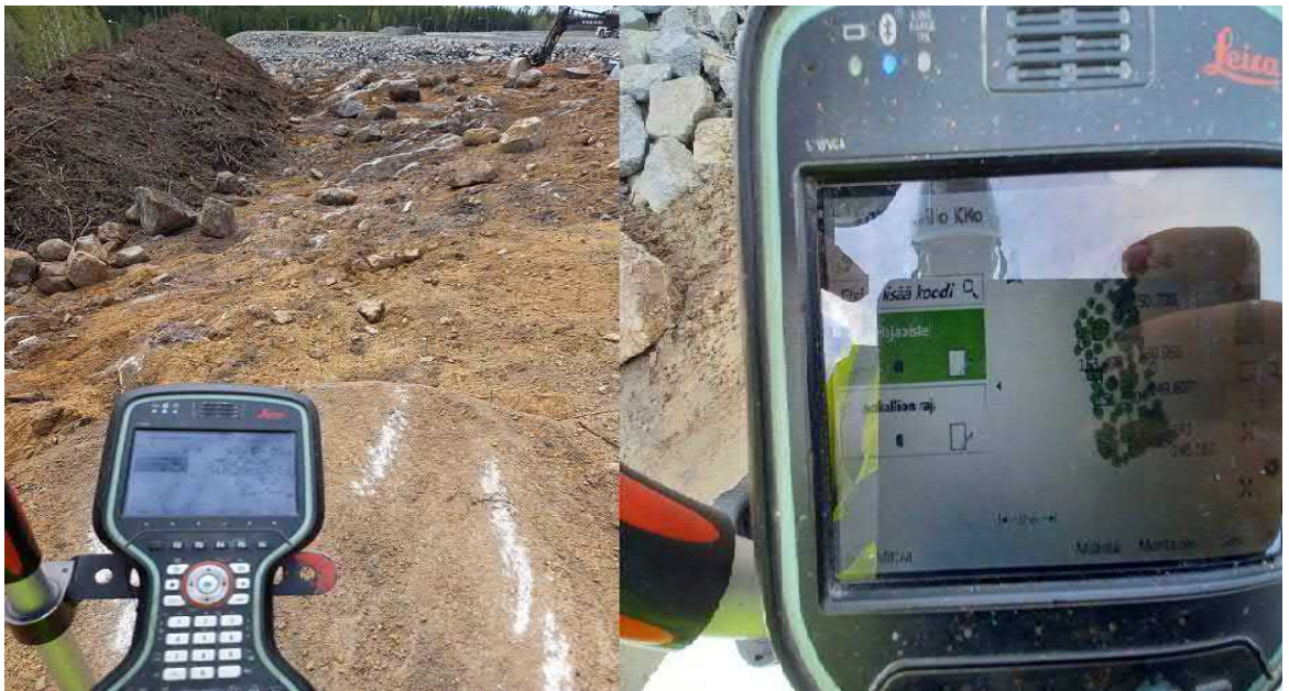
Kuvio 18. Massaleikkauksen jälkeinen maanpinnan mallinnus Leican GNSS-laitteella
