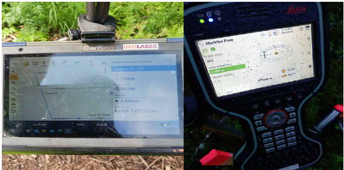
Kuvio 27. Merkintämittausta pohjatutkimuspisteelle Leican laitteilla (oikea) ja tonttihakkuurajan määrittystä Trimblen laitteella merkintälinjaa seuraamalla (vasen)
