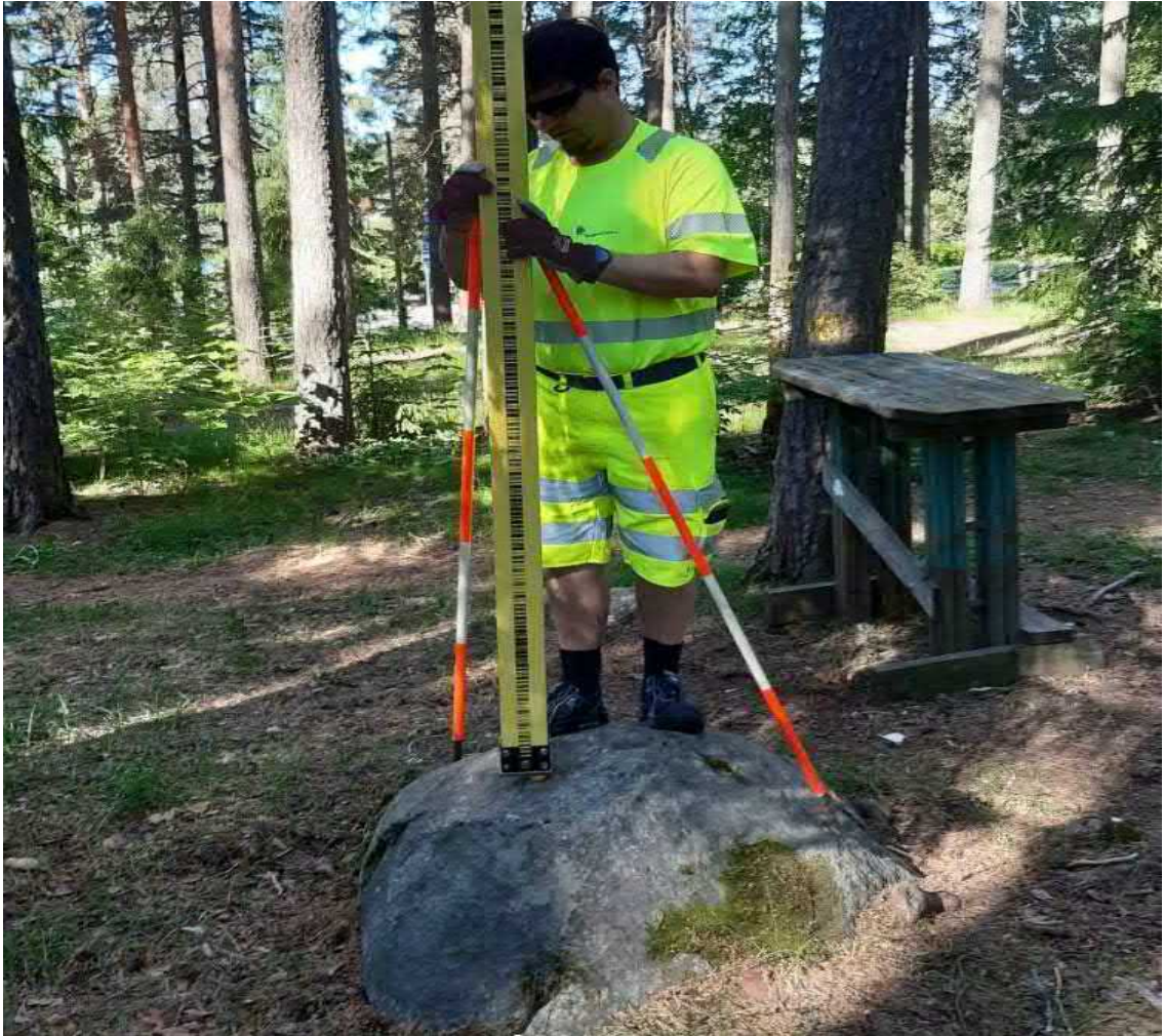
Kuvio 68. Latan pitäminen suorana kiintopisteen päällä (Tampereen Infra Instagram 2022b)
