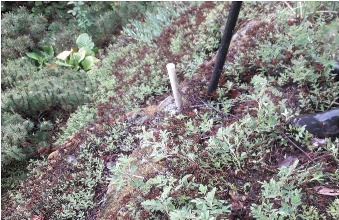
Kuvio 47. Kalliopyykki, jonka päälle on laitettu muoviputki helpottamaan sen löytymistä maastossa
