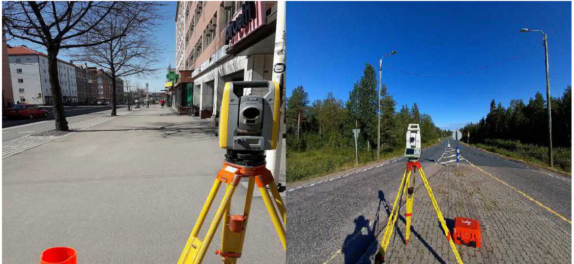
Kuvio 19. Tien risteysalueen ja kaupunkialueen mallinnusta Trimblen (vasen) ja Leican (oikea) takymetreilla
