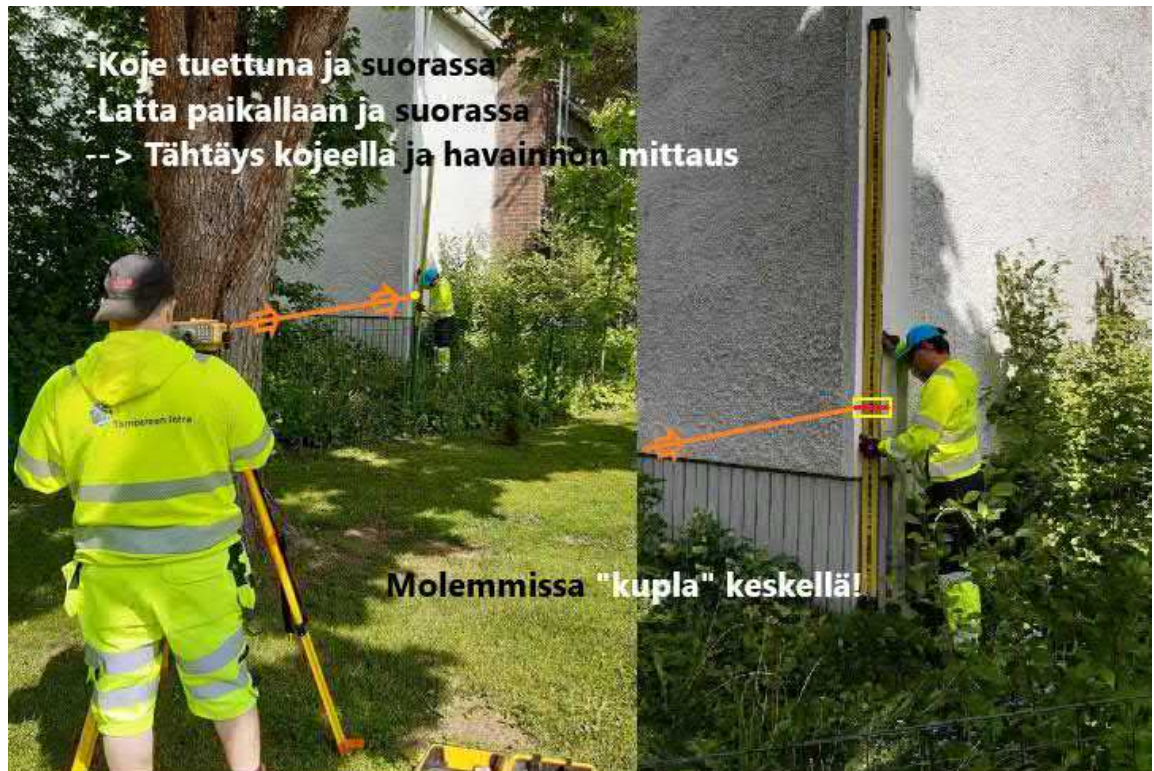
Kuvio 67. Vaaituskoje ja latta korkeuskiintopisteellä (Tampereen Infra Instagram 2023a)
