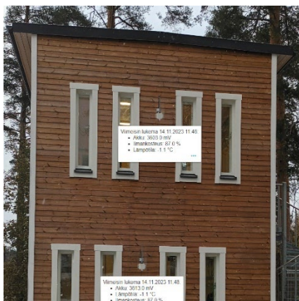
Kuva 73. Sensor World. Testitalon eteläseinä. ELT-2- HP-anturit.
