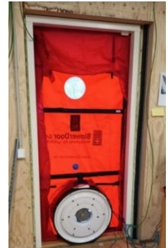
Kuva 49. 1krs. paine- nekoelaitteisto. Mit- taus nro.1.
