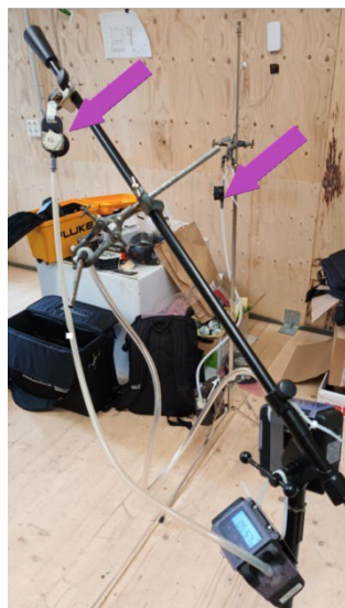
Kuva 68. Hiukkasten keräys näytekasetteihin
