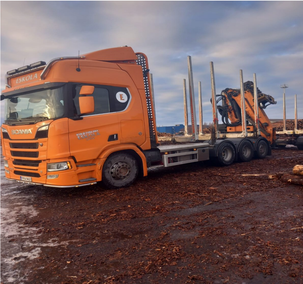
Kuvio 9. Z-puominen puutavaranoستuri kuljetusasennossa.
