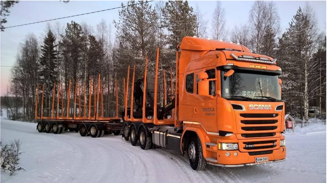
Kuvio 10. Suorapuominen puutavaranosturi kuljetusasennossa.
