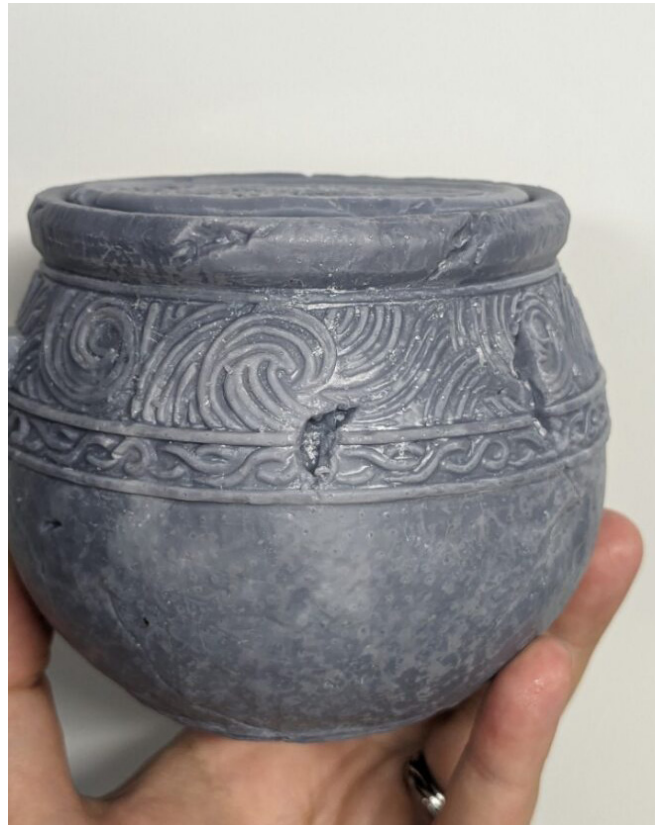
Kuva 5. SLA-tekniikalla tulostettu kulho.
