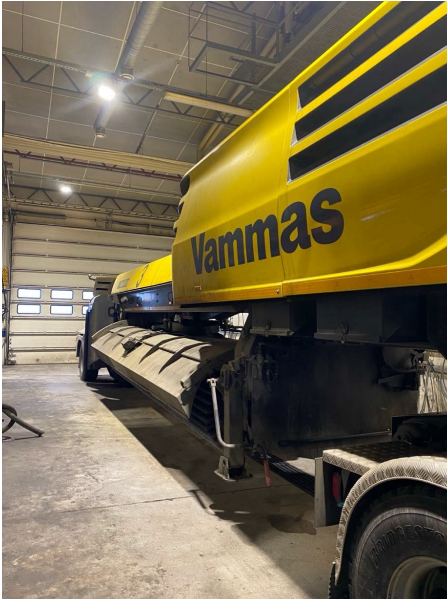
Kuvio 5. Lentokentällä käytettävä harjakone (Stoor 2024)
