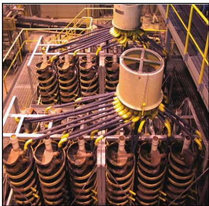
Kuva 12. Hienorikastuksen spiraalierottimet (Rissanen & Peronius, 2013, 63.)
