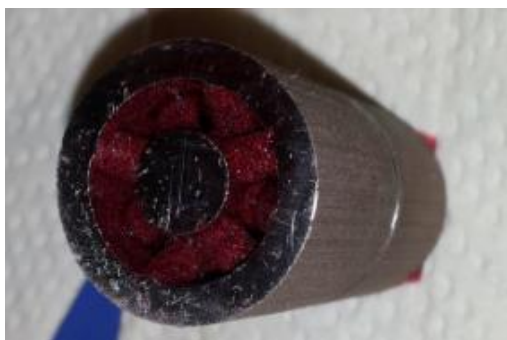
Kuva 44. Tarkastus 1: tunkeumaneste kappaleen sisäpinnalla
