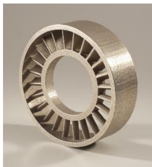
Kuva 4. 3DP-tekniikalla valmistettu roottori (EXONE 2012)
