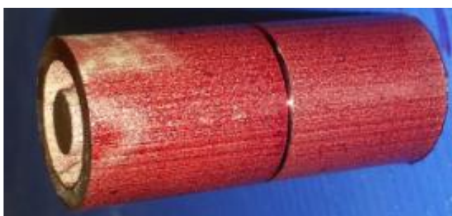
Kuva 46. Tarkastus 2: tunkeumaneste koekappaleen ulkopinnassa
