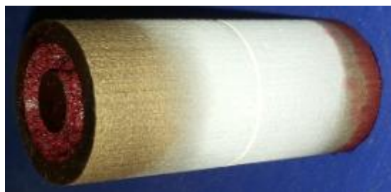
Kuva 45. Tarkastus 1: kehite kappaleen ulkopinnassa
