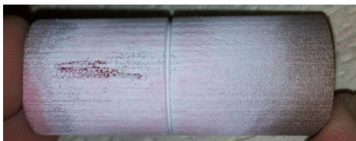
Kuva 47. Tarkastus 2: kehite koekappaleen ulkopinnassa. Särö punaisen tussin osoittamalla puolella ja paikalla
