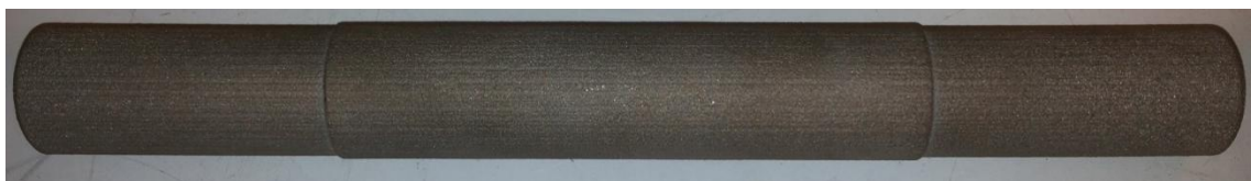
Kuva 27. 420/Pronssi -koekappale valmistettuna 3DP-tekniikalla
