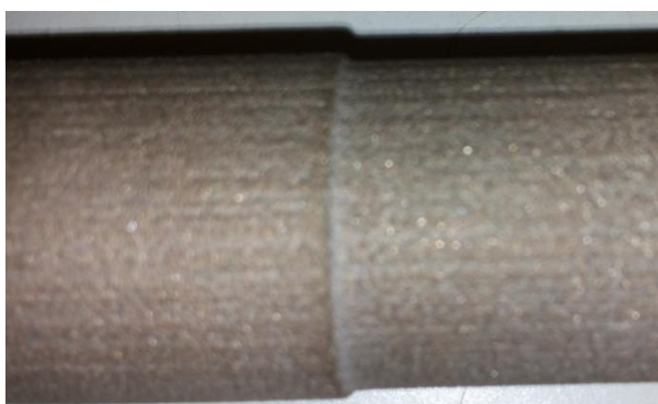
Kuva 31. Kohdistusolake ja vaipan paksunnus 3DP-koekappaleessa
