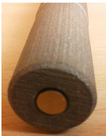
Kuva 30. Jauheen poistoreikä tukittuna 3DP-koekappaleessa
