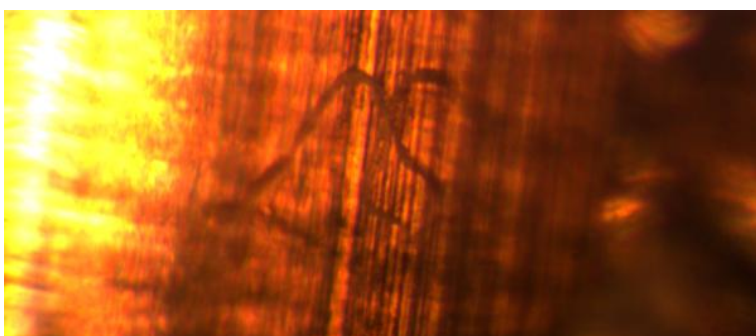
Kuva 55. Haarautunut mikrosärö uran keskellä
