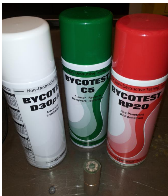
Kuva 43. Testiin käytetyt tunkeumaneste, kehite ja puhdistusaine
