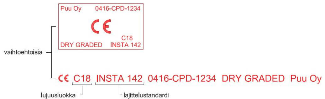
Kuva 6. Esimerkkejä CE-merkityn lujuuslajittelun sahatavaran lujuusleimoista. [9.]
