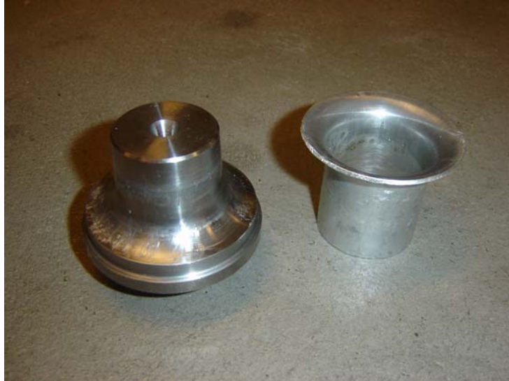
Kuva 53 Muotti ja valmis kiihdytyspippilo
