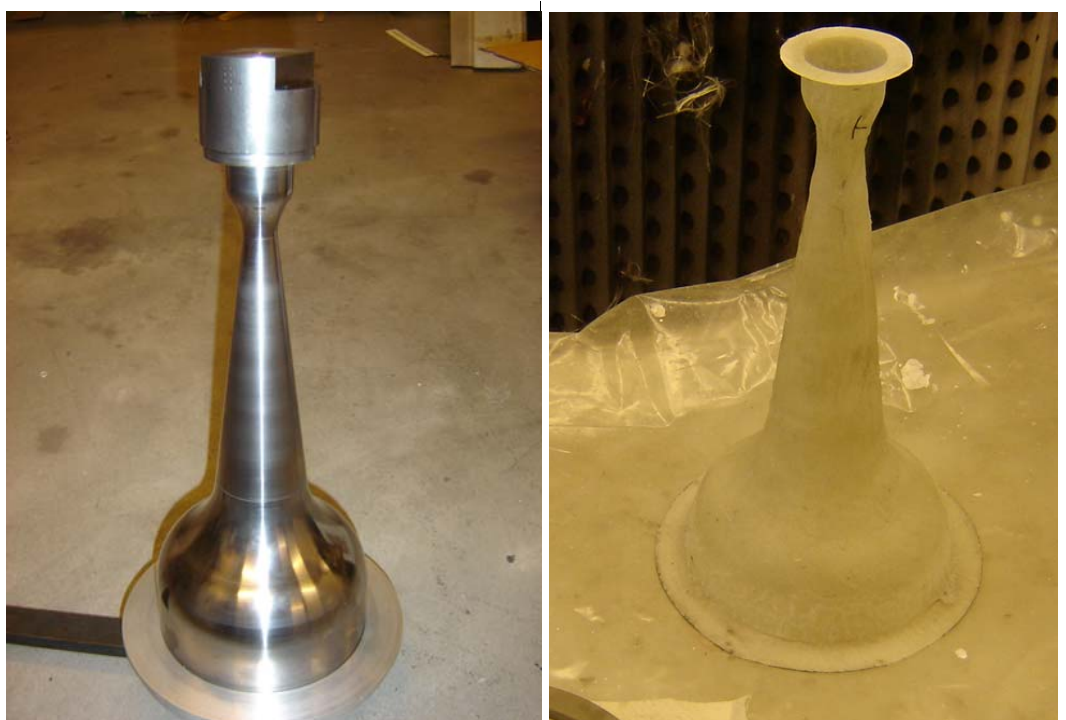
Kuva 54 Imusarjan kuristinosan muotti ja valmis kappale
