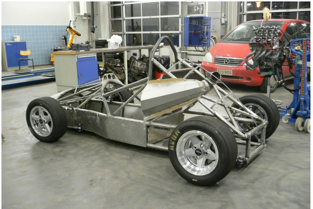
Kuva 1: SFR-auton runko lähes valmiina.
