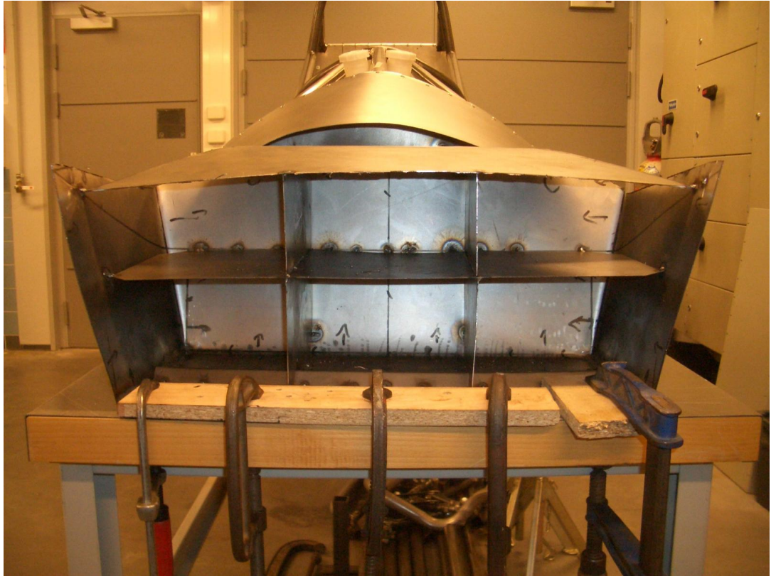
Kuva 19: Crashboxin osastoista koostuva rakenne.
