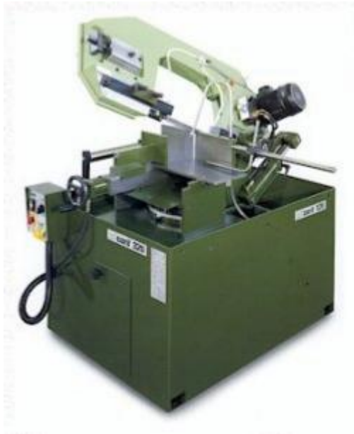
Kuva 14: Carif 260 BSA -vannessaha.
