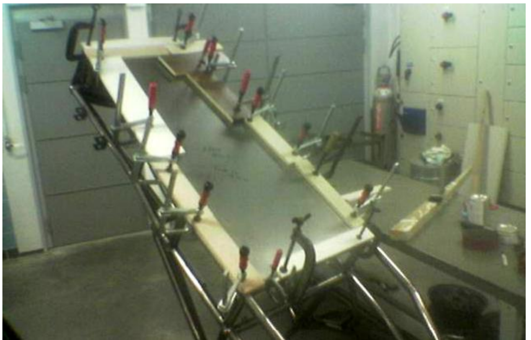
Kuva 15: Pohjalevy liimattuna ja kuivumassa.
