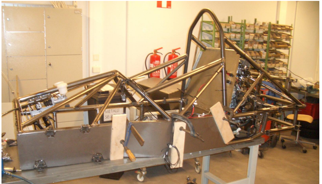
Kuva 17: Kylkilevyn muotoilu puristimien avulla.
