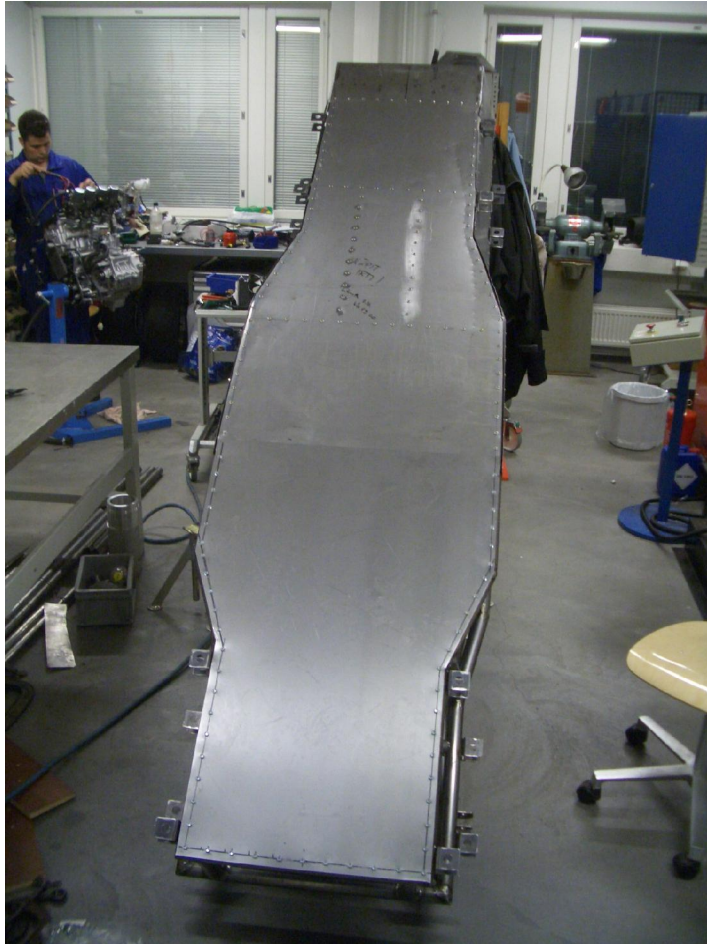
Kuva 22: Auton valmis tasainen pohja.
