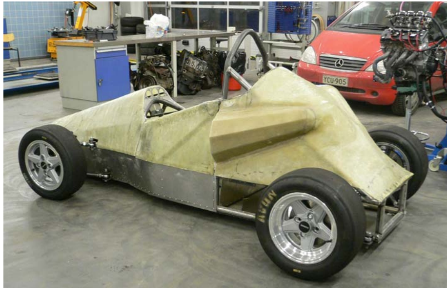
Kuva 34. Kate pintakäsittelyä vaille valmis
