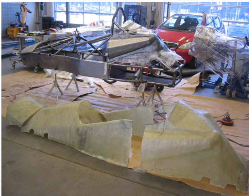
Kuva 32. Kate irrotettuna muotista
