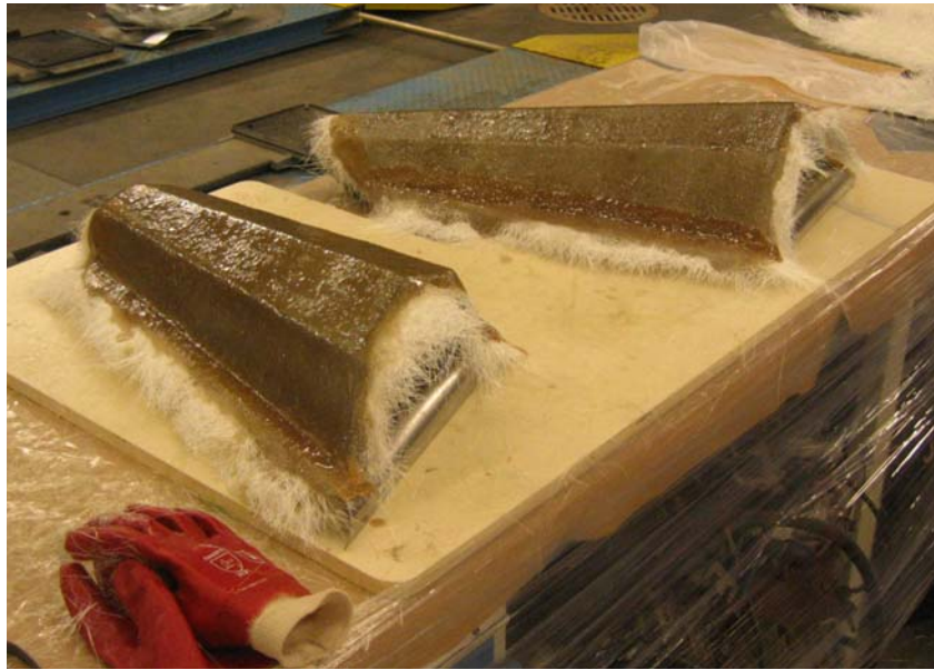
Kuva 31. Ilmanottoaukkojen katteiden uudelleen laminointi
