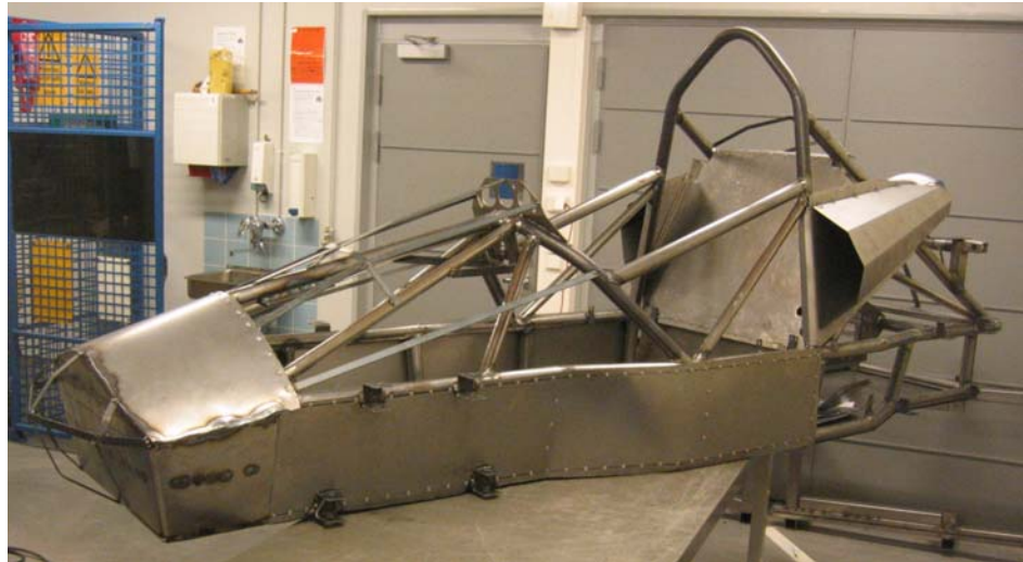
Kuva 28. Korin muotojen tukiraudat
