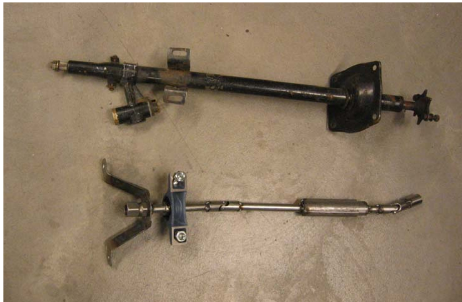
Kuva 21. Saab 96:n ja kilpurimme ohjausakselit
