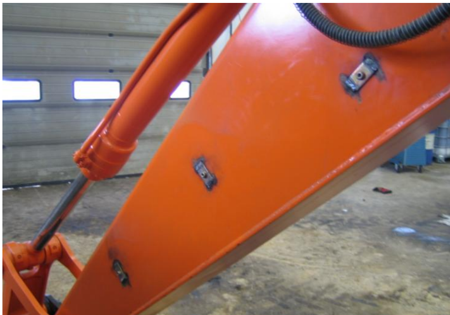
Kuva 33 Putkikiinnikkeiden kohdat taittopuomissa
