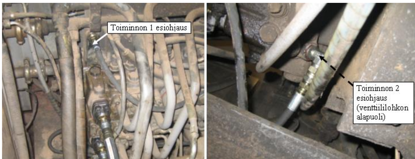
Kuva 51 Luiskahydrauliikan esiohjausliitäntöjen sijainti venttiililohkossa
