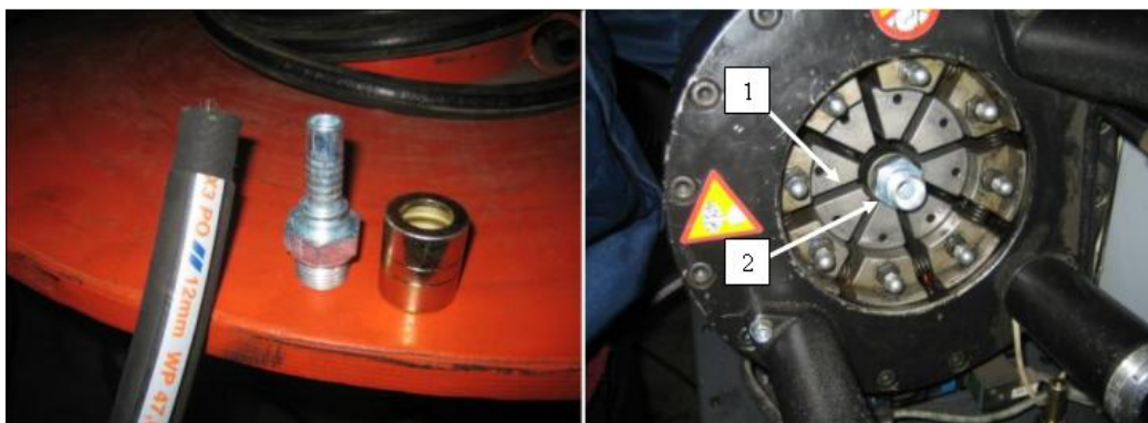
Kuva 39 Liittimen osat ja puristustilanne
