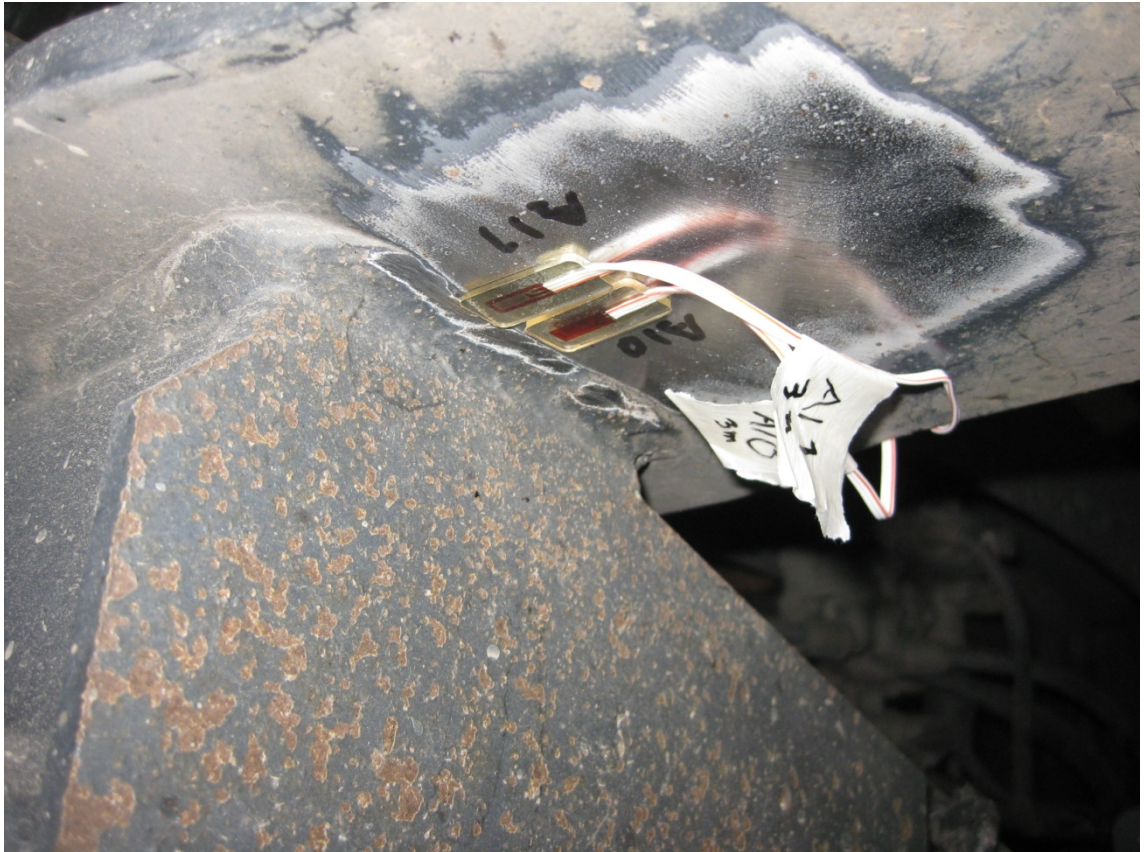
KUVA 18. Takatelin ensimmäisen akselin hot spot -jännitystä mittaavat liuskat (Kuva: Kalle Seppälä 2014)
