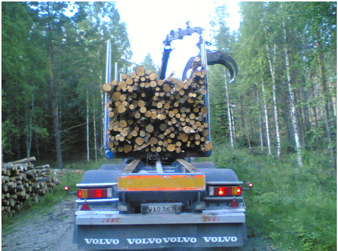
KUVA 22. Siirtopankkoperävaunun takimmainen nippu ajettuna eteen kuormausasentoon (Kuva: Kalle Seppälä 2005)
