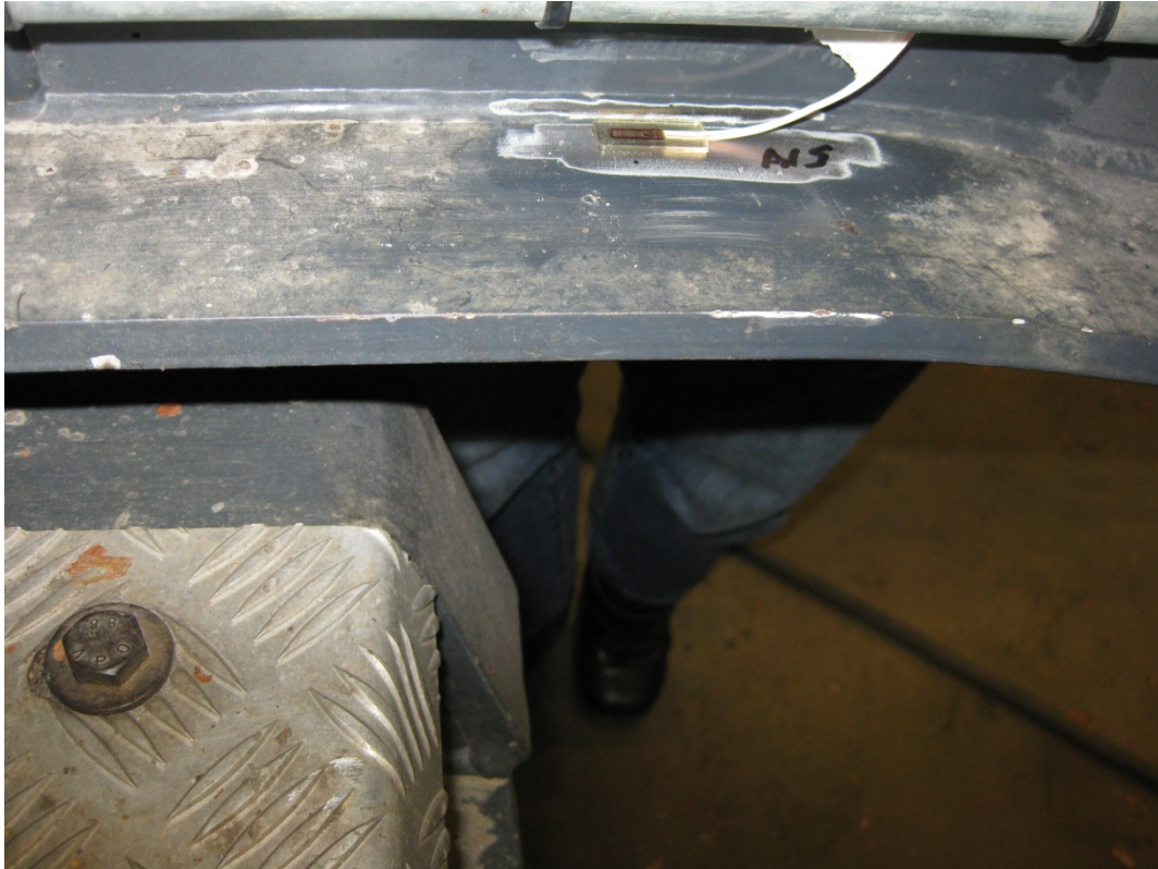
KUVA 19. Runkopalkin taivutusta mittaava alempi venymäliuska (Kuva: Kalle Seppälä 2014)
