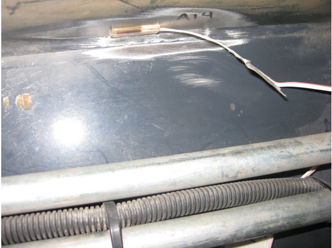
KUVA 20. Runkopalkin taivutusta mittaava ylempi venymäliuska (Kuva: Kalle Seppälä 2014)
