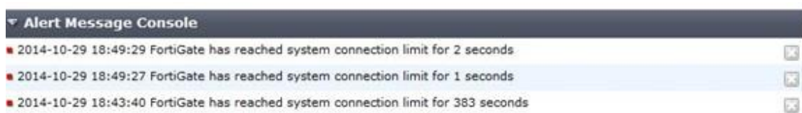
Kuva 22. FortiGate palomuri on hyökkäyksellä lamautettu.
