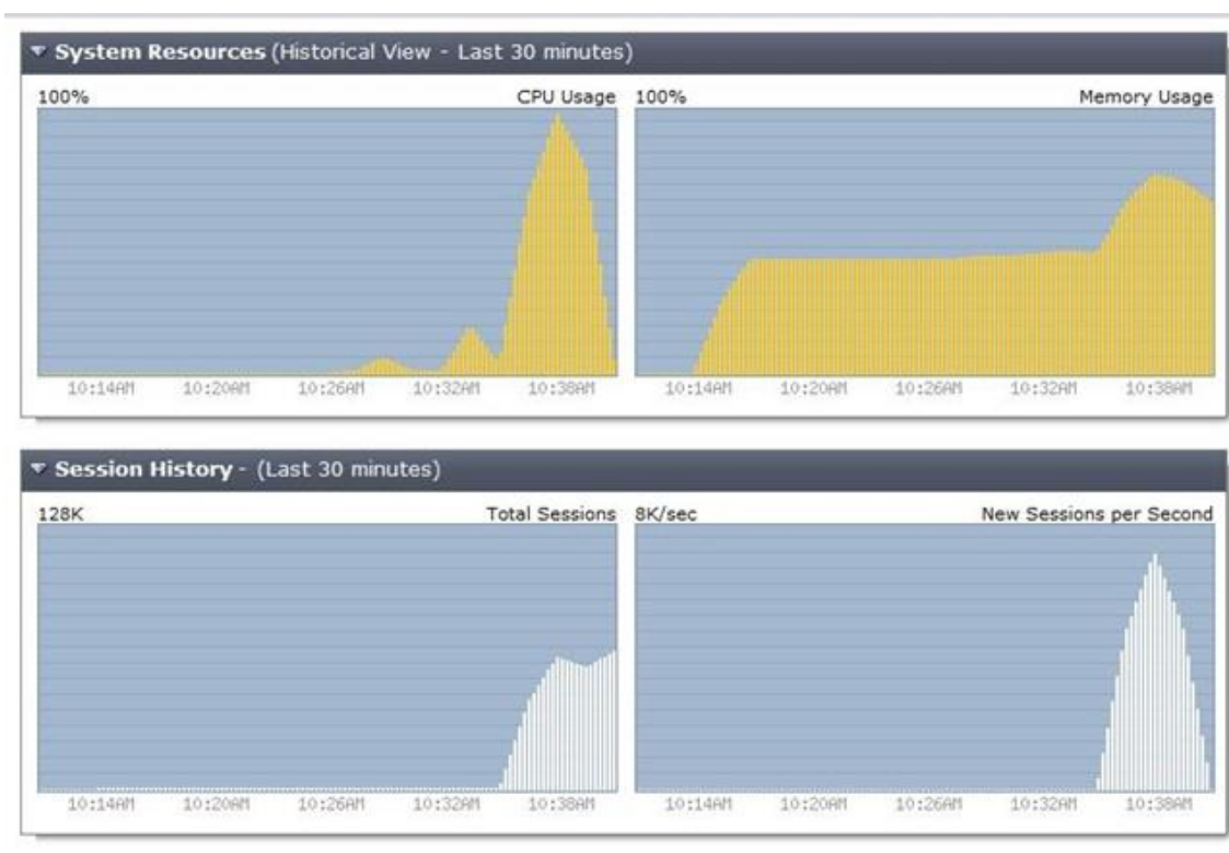
Kuva 23. Palomuurin järjestelmä-resurssit olivat kovilla hyökkäyksen aikana. Hyökkäysliikennettä pyrittiin käsittelemään ja tämä vaati tehoa prosessorilta ja välimuistilta. Hyökkäyspakettien luomat istunnot näkyvät myös grafiikassa.
