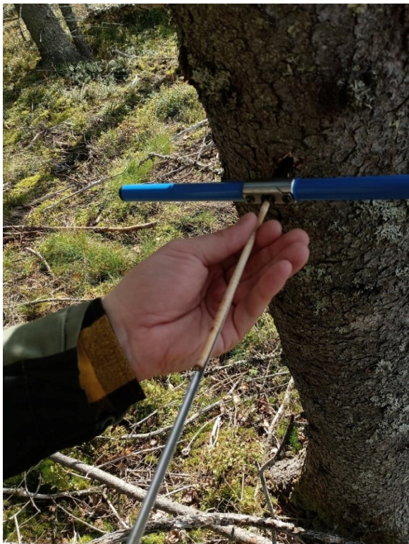
Kuva 11. Näyte vedetään ulos tarttumatikulla.
