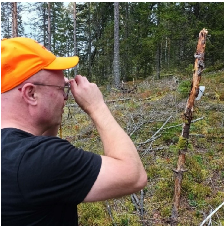
Kuva 8. Bussolilla tarkistetaan kulmien suuruudet ja alueen symmetrisyys.
