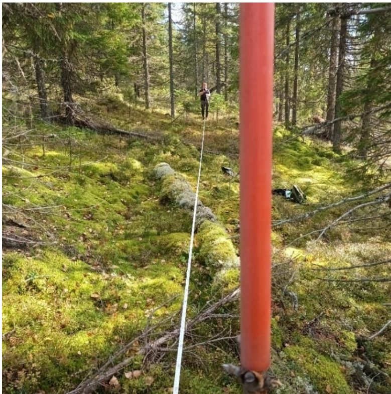
Kuva 7. Koeala rajataan niin, että sen kulmapisteiden sivut ovat 20 metrin päässä toisistaan.
