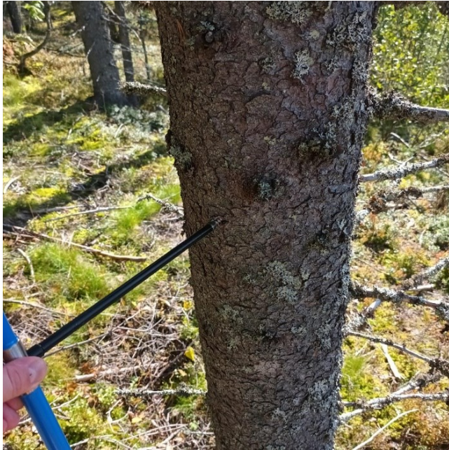
Kuva 10. Poraus aloitetaan rinnankorkeudelta oksattomasta kohdasta.
