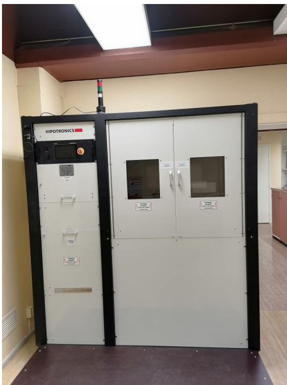
KUVA 4. Hipotronics 700/800-DI-läpilyöntilaitte (Kuva: Marjo Mäki)
