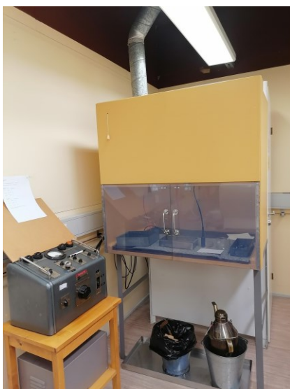
KUVA 1. Ferranti läpilyöntilaitte (Kuva: Marjo Mäki)
