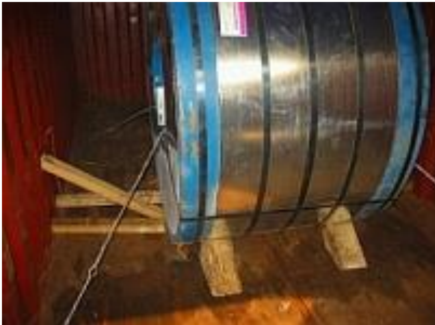
Kuva 3. Teräskela ”varmistettuna” kontissa. (Kaps 2002-2014, 3.)
