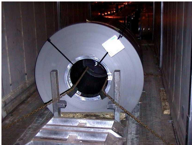
Kuva 12. Yli 10 tonnia painava kela standardin EN 12195-1 mukaisesti tuettuna maantiekuljetuksessa. (European Commission)
