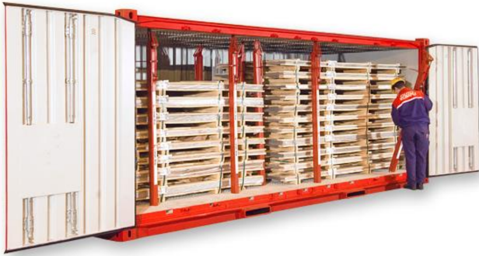
Kuva 10. Levynippujen tuentaa patentoidulla tuentatolppajärjestelmällä. (Langh Ship Oy 2012c)
