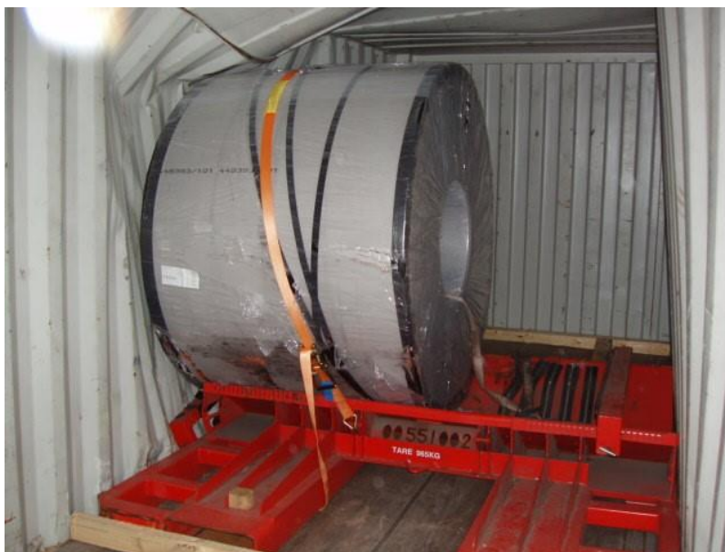
Kuva 16. Coil-Taineriin lastattu kela on irronnut kiinnityksistään. (Ylikahri 2014)
