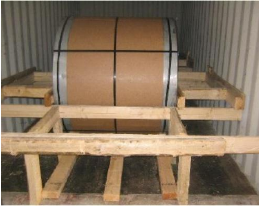
Kuva 1. Teräskelat ”tuettuna” yleiskäyttöön tarkoitettuun konttiin. (Yusen-Logistics)
