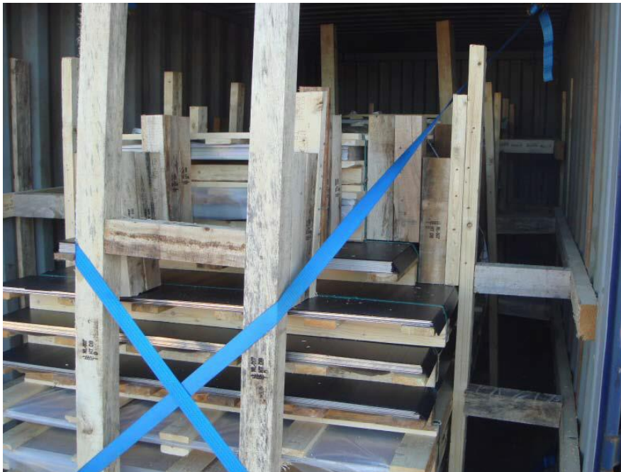
Kuva 2. Teräslevyjä ”tuettuna” yleiskäyttöön tarkoitettuun konttiin. ( Lanh Ship Oy 2012a)
