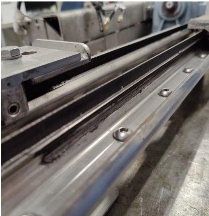
KUVIO 3. Johteet kuluvat epätasaisesti työntimen raskaan painon sekä raskaan laatikon työnnön seurauksena.
