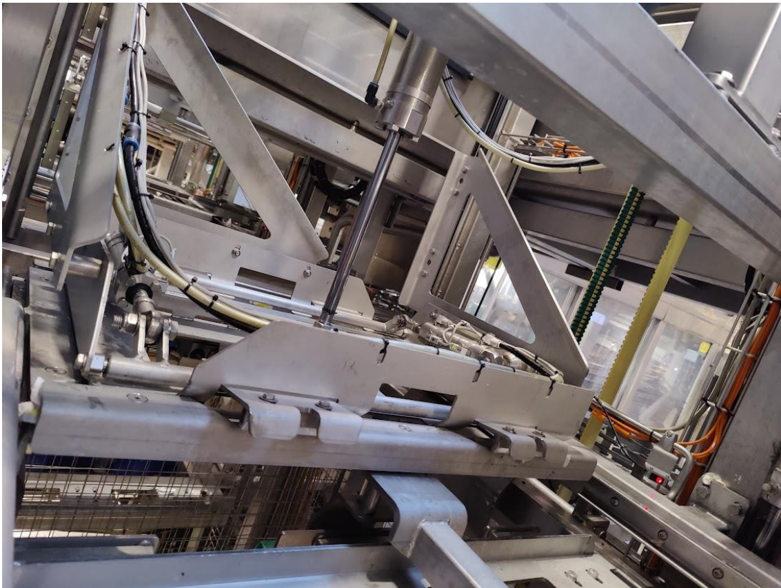
KUVIO 15. Tarttujan paineenpitoventtiili on pettänyt ja tarttuja on laskeutunut painon takia alas.
