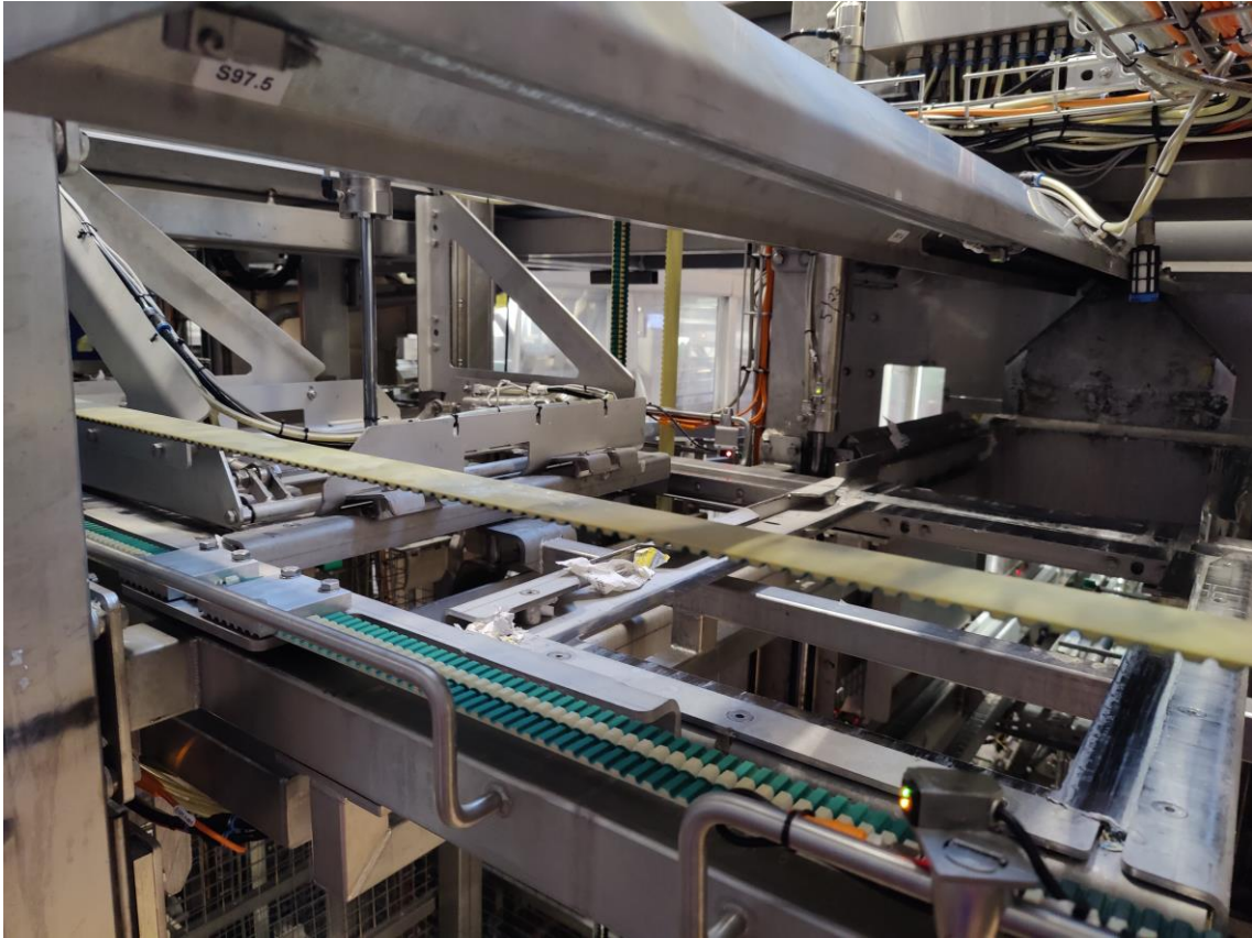
KUVIO 11. Siirtopöytä ja laatikon tarttuja, joka laskee laatikkopinon siirtovaunulle.
