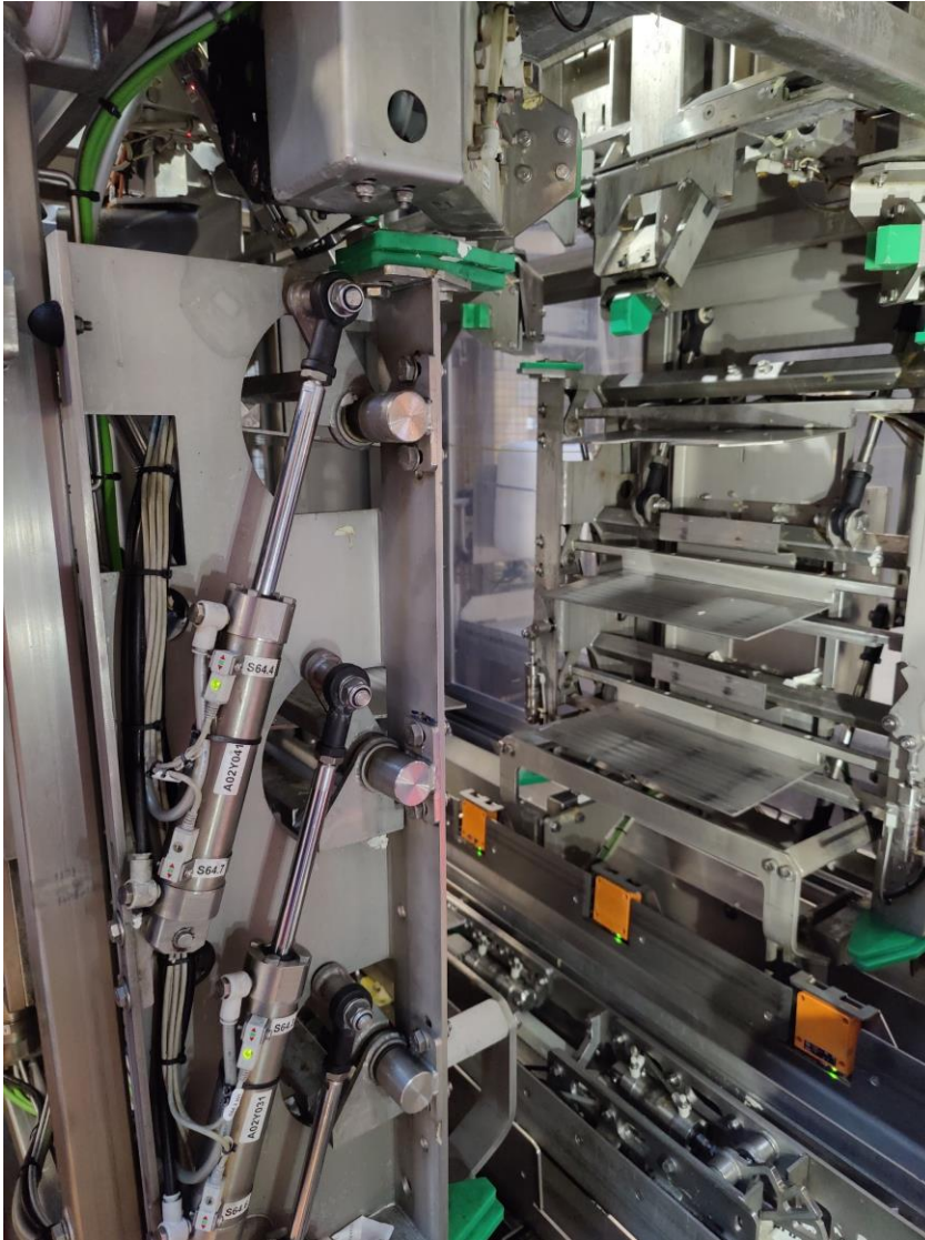
KUVIO 6. Rullakonoikaisija tyhjänä. Etualalla näkyvät sylinterit, jotka muodostavat paininlevyille liikkeen. Taka-alalla on paininlevyjä.
