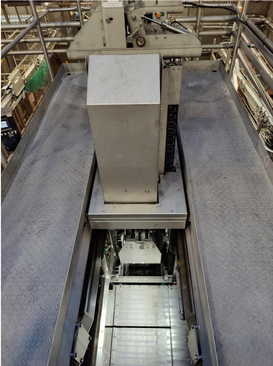
KUVIO 8. Tarttuja kuvattuna koneen yläpuolelta. Purkkitarttuja sijaitsee pöydän taka-alalla.
