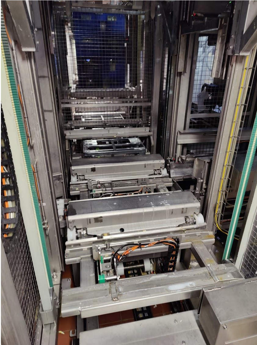
KUVIO 12. Siirtovaunu kuvattuna koneen perältä. Keskellä siirtovaunua on rullakoppaikka, laidoilla laatikoille tarkoitetut paikat.
