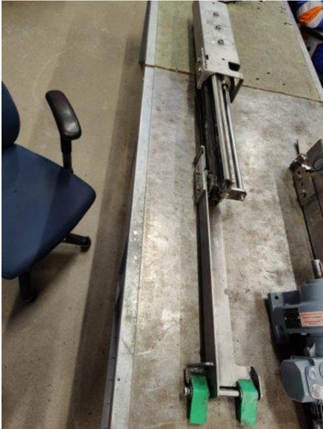
KUVIO 2. Laatikontyönnin irroitettuna. Tästä kuvasta voi havaita, kuinka pitkän matkan työnnin kulkee.
