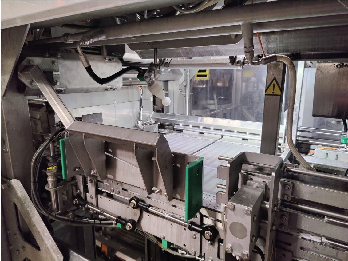
KUVIO 7. Purkkiryhmittelijä. Edessä näkyy työnnin, jonka liikkuminen tapahtuu remmillä ja se liikkuu johteita pitkin.
