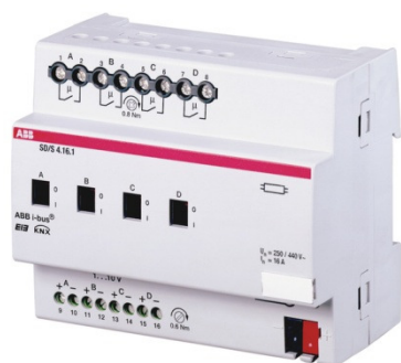
KUVA 9. 4-kanavainen 1-10V:n säädinyksikkö, 16A ABB SD/S4.16. 1 (ABB 2012b, 67.)
