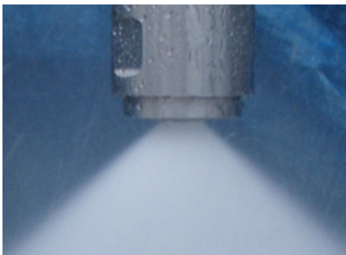
Kuva 4. Korkeapainesuihkusuutin ja suihkukuvio (Andritz, 2017, 31)
