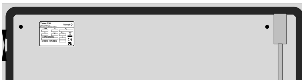
KUVA 7. Arvokilpi suunnittelukuvassa keskuksen oven sisäpuolella
