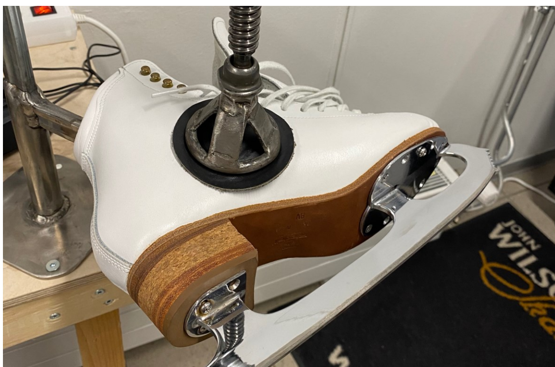
Kuva 1. Luistimen paikallinen venytys veneluun kohdalta paineen vähentämiseksi (Roosa Latvala 2024).
