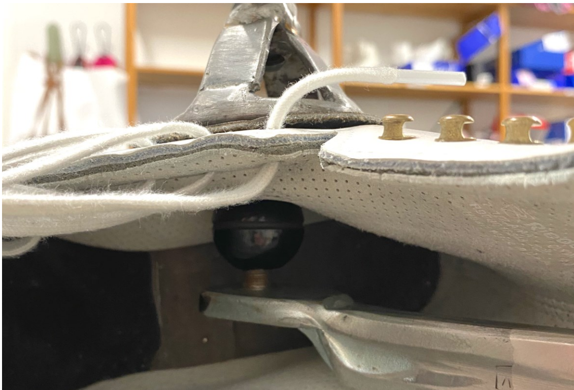
Kuva 2. Luistimen paikallinen venytys veneluun kohdalta paineen vähentämiseksi (Roosa Latvala 2024).
