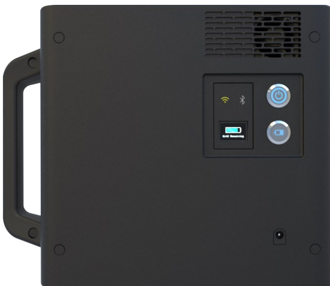
KUVA 2. Matterport Pro2 3D – Kameran takaosa (Matterport 2024a).
